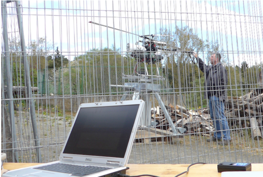
Flugplattform auf Prüfstand kurz vor Beginn eines Testlaufs. Messrechner zur Auswertung der Kräfte am Prüfstand. Doppelter Schutzzaun zur Sicherheit der Betreiber.
