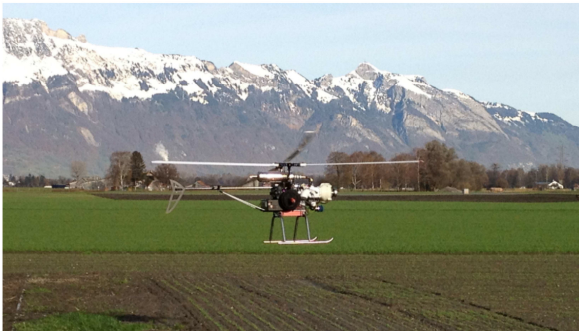
Flugplattform mit Avionik-Einheit (rot unter dem Fluggerät). Generator-Modul, Akku-Ladeinheit, geregelte Spannungsversorgung für Aktoren, Autopilot, Payload. Mischer Elektronik und Autopilot-Integration.
