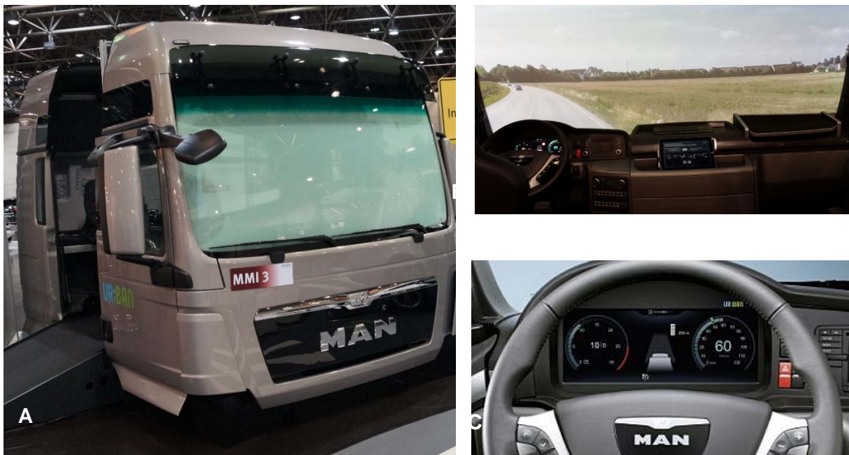
Abbildung 3-24: (A): Außenansicht des Demonstrators; (B) Innenansicht mit Projektion der Fahrszene; (C) Kombidisplay mit MMI-Konzept
