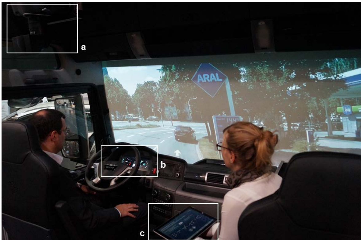
Abbildung 3-25: Innenansicht des Demonstrators: a) Projektion auf Frontscheibe; b) Kombidisplay mit MMI Konzept; c) Steuerung über Tablet
