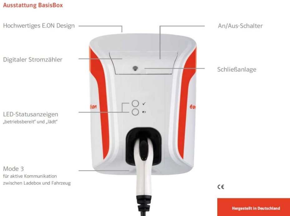
Abbildung 2.5: Wallbox BasisBox Kombi (Abb. ähnlich), (Quelle: E.ON)
