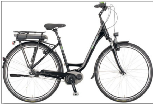
Abbildung 29 - Pedelec VSF Fahrradmanufaktur P50 Bosch Mittelmotor 400Wh Quelle: VSF Fahrradmanufaktur, 2014
