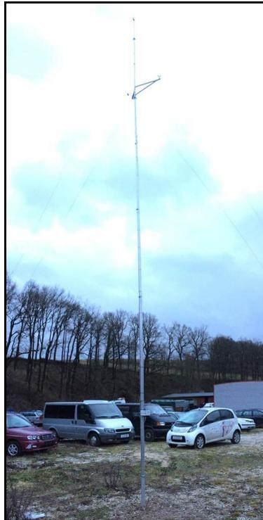
Abbildung 23 Windmessmast auf dem Betriebsgelände des ASD
