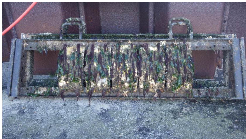
Abb. 6: beschichtete Probe nach der Auslagerung
