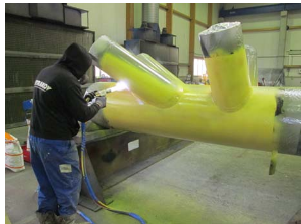
Abbildung 16: Beschichten des Demonstratorbauteils mit PA12-Pulversystem
