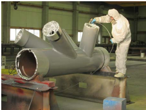
Abbildung 15: Beschichten des Demonstratorbauteils mit Primersystem
