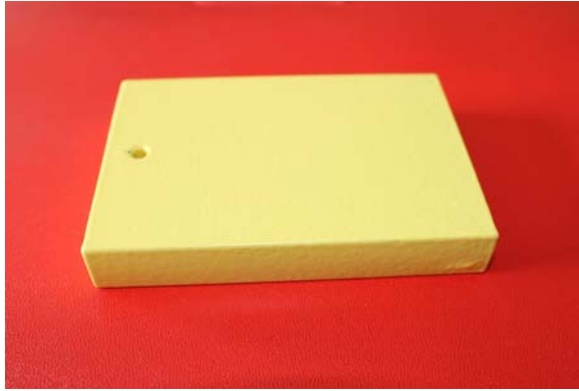
Abb. 14: Beschichtete Stahlprobe mit großer Wandstärke
