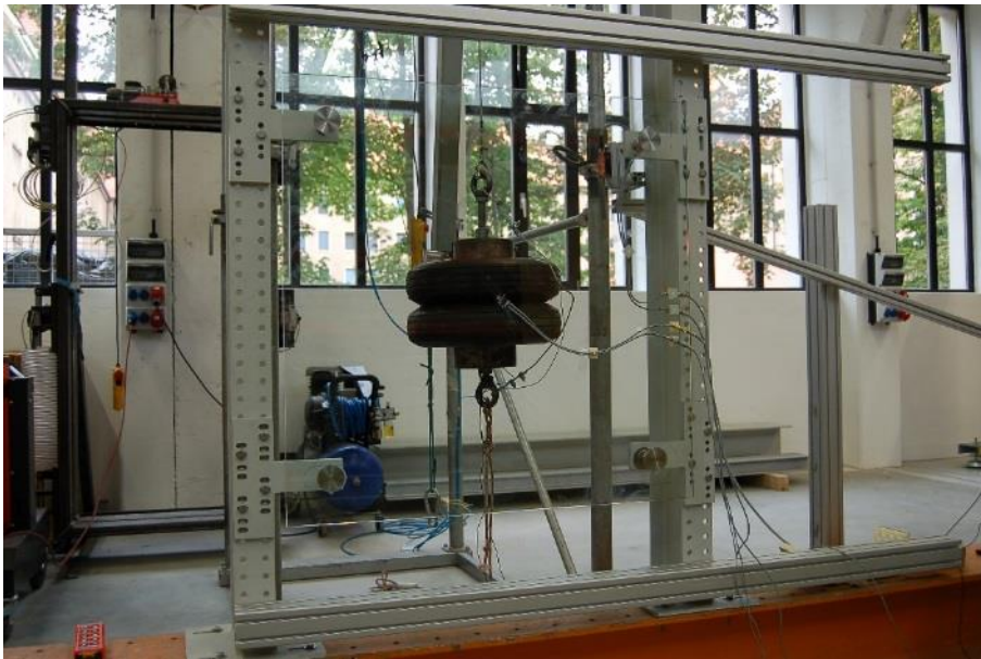
Bild 16 Versuchsaufbau zur Prüfung einer punktgehaltenen Brüstungskonstruktion mittels Pendelschlagversuch.
