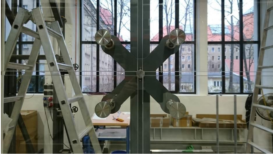
Bild 21 Punkthalteranschlüsse starres Fassadenmuster (Pfosten-Riegel-Fassade) - Mittelknoten
