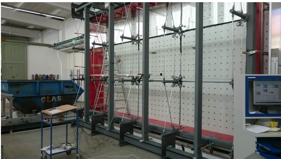
Bild 23 Versuchsaufbau einer Seilnetzfassadenkonstruktion zur Prüfung von Winddruck- und Windsoglasten.
