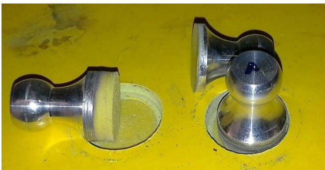
Abb. 42 Liegender Stempel links: Kohäsionsbruch nahe der Substratgrenze Platte 1309-04; liegender Stempel rechts von Platte 1309-02: Bruch an der Oberfläche der Beschichtung und zum Teil Adhäsions- bruch zwischen Kleb- stoff und Beschichtung
