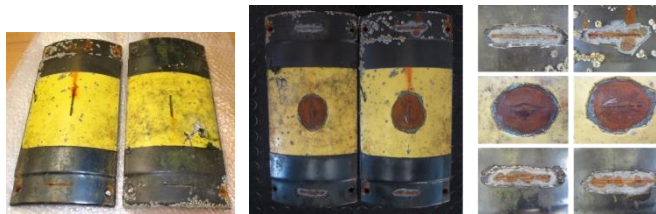
Abb. 24 Zwei Rohrsegmente der Entnahme aus der Auslagerung auf Helgoland
