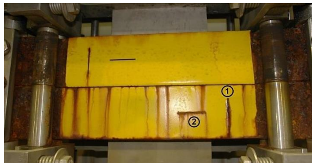
Abb. 39 Lage der Fräsnut (1) vertikal; (2) horizontal
