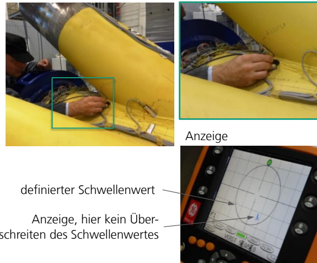
Abb. 74 Durchführung der Prüfung; Führung des Sensors und Darstellung auf dem Handmonitor
