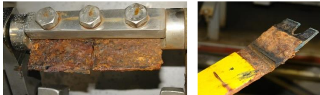
Abb. 44 links: Durchgerostete Probenenden; rechts: durch Korrosionsfortschritt geschwächte Probe
