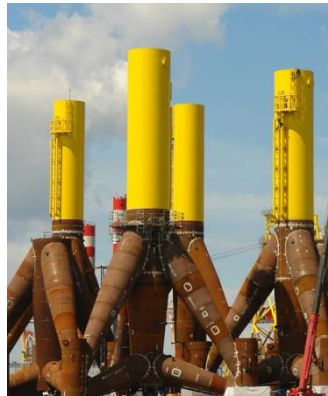
Abb. 05 Gründungsstrukturen in Bremerhaven; links: Jackets, rechts: Tripods
