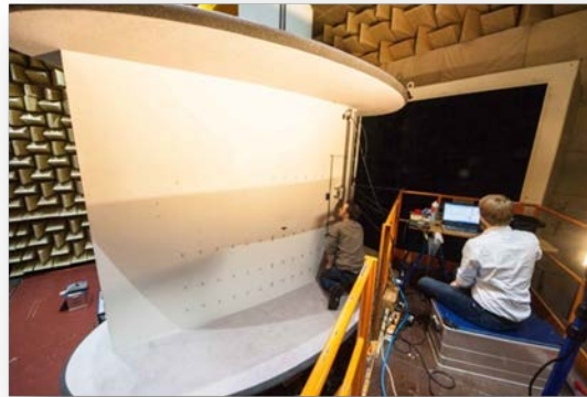
Abbildung 2-3: Einbau des 2D Modells in die Messstrecke des DNW-NWB
