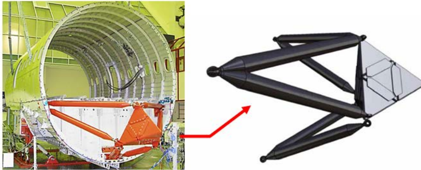
Abbildung 2-85: Zusatzmasse (Tetragon) mit Fixationsstäben
