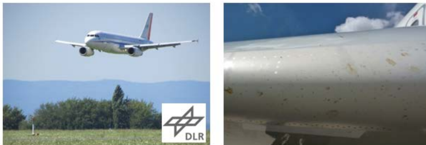
Abbildung 2-21: Flugversuche zur Insektenkontamination mit dem DLR ATRA.
