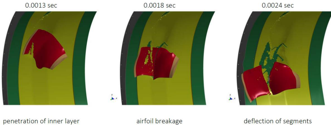
Abbildung 16: Fanschaufeleinschlag Phase 2
