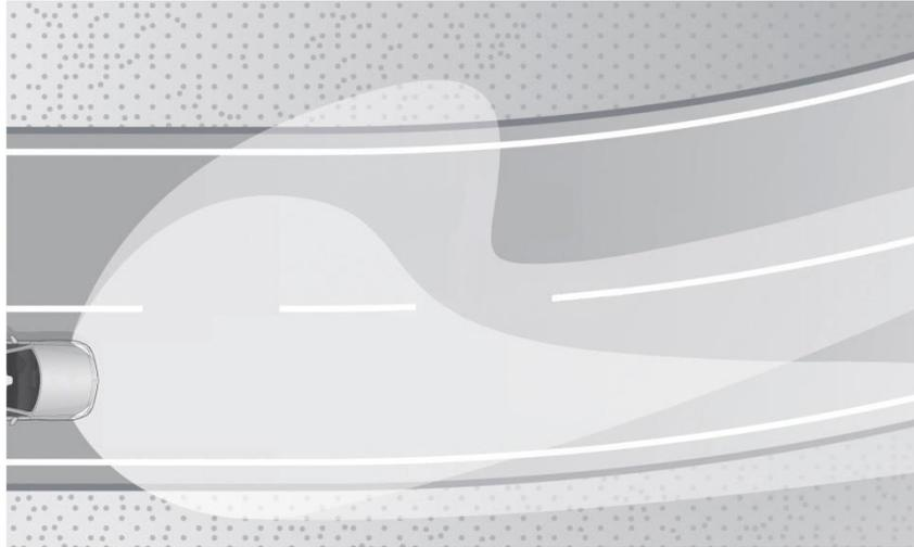
Abbildung 44: Scheinwerferhauptstrahl angepasst an den Straßenverlauf.
