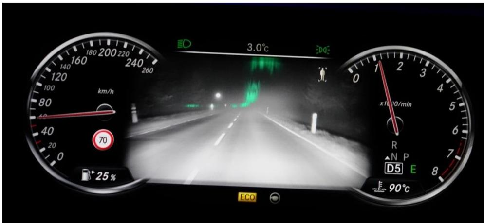
Abbildung 45: Augmentiertes Nachtsichtbild im Kombiinstrument des Fahrzeugs. Der Straßenverlauf wird durch die eingeblendete Nordlicht-Markierung angezeigt.
