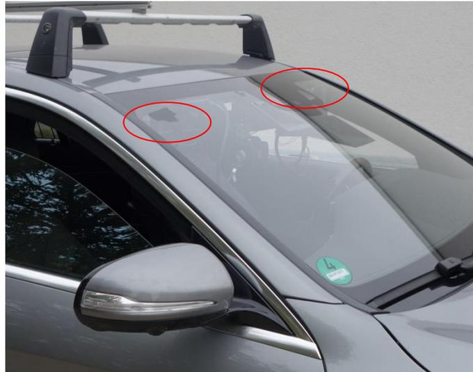
Abbildung 41: Montageort der zwei Nah-Infrarot-Kameras hinter der Windschutzscheibe
