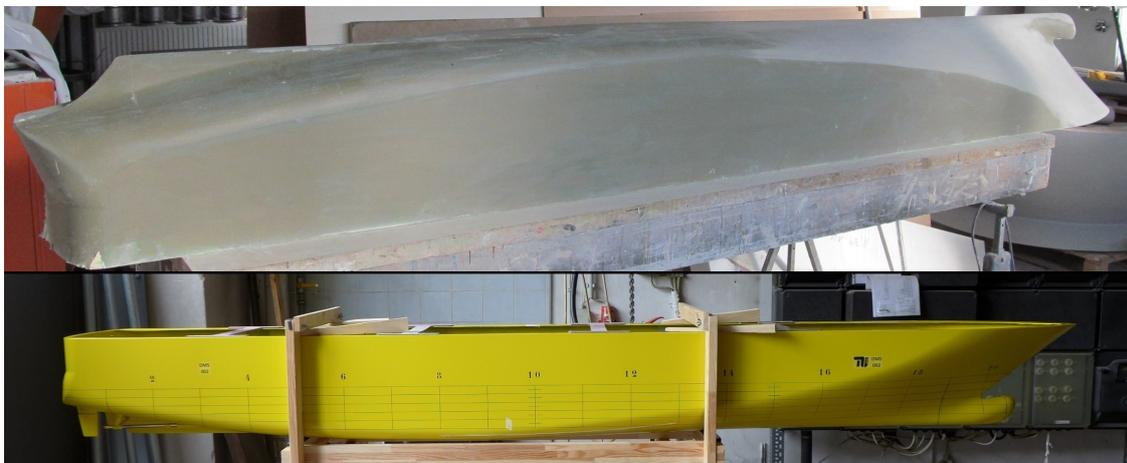
Abbildung 3.9: Schiffmodell - Rohbau und fertiges Modell
