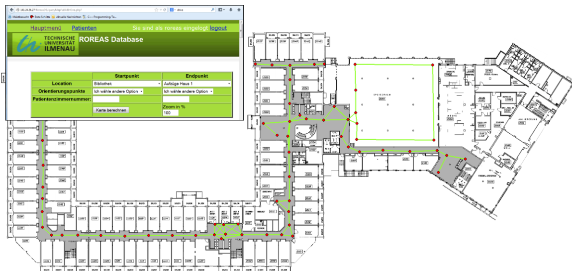
Abbildung 18: Entwicklung einer Datenbank mit Daten aus CAD-Plänen der m&i-Fachklinik, allen Patientenzimmern, fahrbaren Wegen, Ruhepunkten und Orientierungsfakten mit Bildern. Diese Daten können über ein Webinterface eingetragen und zur Ermittlung von Wegstrecken abgerufen werden ( oben links ).
