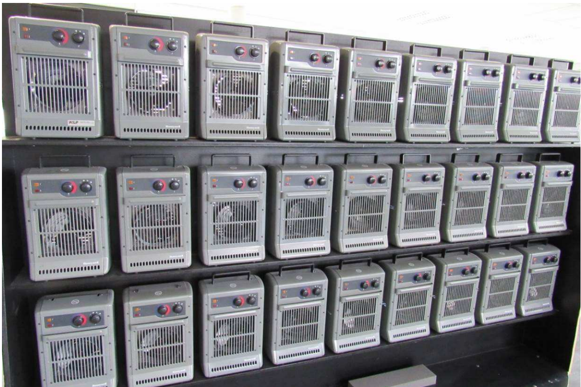
Abbildung II-26: Aufbau des 115V 400 Hz Lastsimulators
