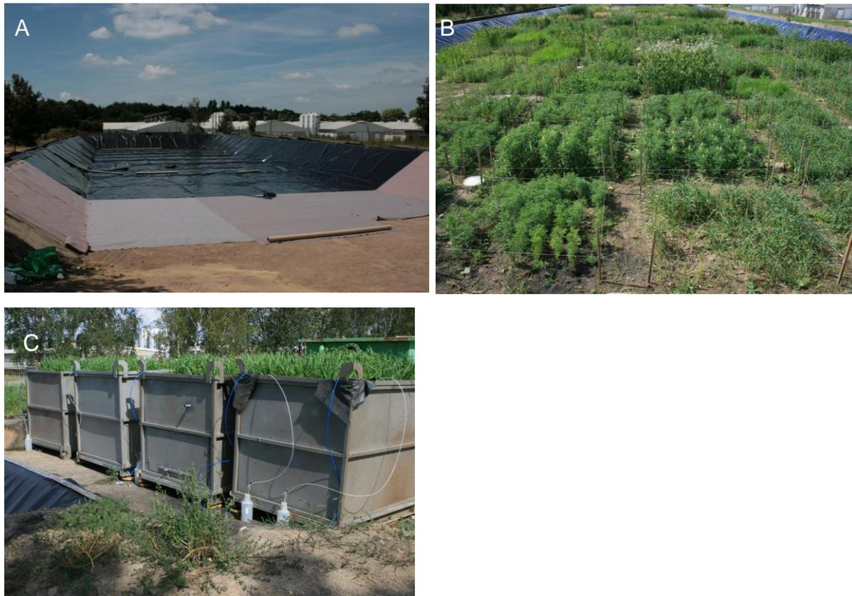
Abb. 2: Versuchsanlagen auf dem Gelände der BAUER Umwelt GmbH. A) Installation der Dichtfolie im Versuchsbecken, B) vollrandomisierter Bepflanzungsversuch im August 2014, C) bepflanzte Festbettreaktoren für den a priori-Test von geeigneten Behandlungsvarianten.
