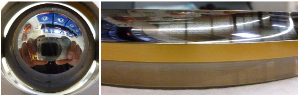
Abbildung 33: Lager nach dem Lastumkehrversuch: Links: Stahlkugel, rechts: Innenringlaufbahn
