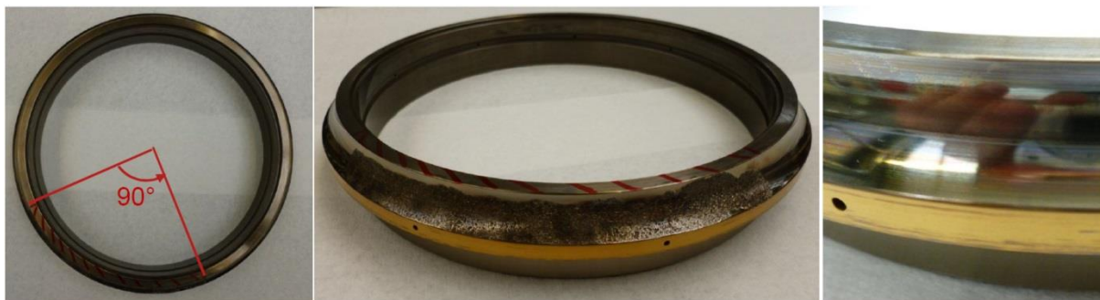
Abbildung 38: Zustand des Versuchslager nach dem Ausfall; Links: Die Außenringlaufbahn weist Abdrücke und Eindrücke auf; Rechts: Käfig und nicht vorgeschädigte Kugeln weisen keine Schäden auf
