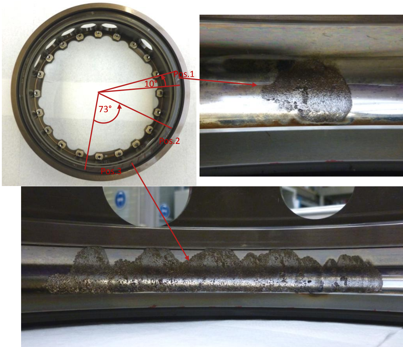
Abbildung 9: Schaden am Außenring des Versuchs mit M50-Außenring
