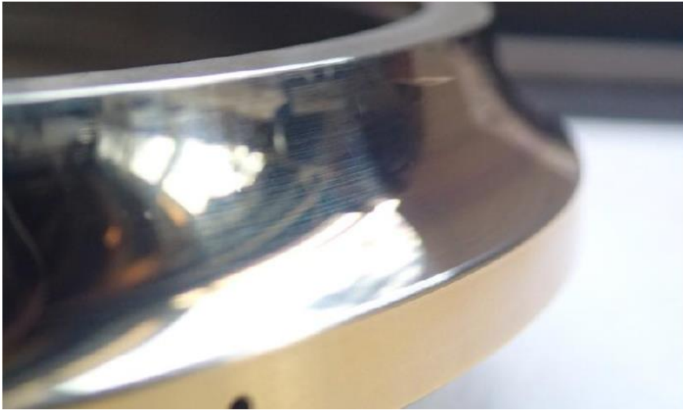
Abbildung 13: Belasteter Innenring des Hybridlagers mit konventionell gehärteten Ringen (594685A)
