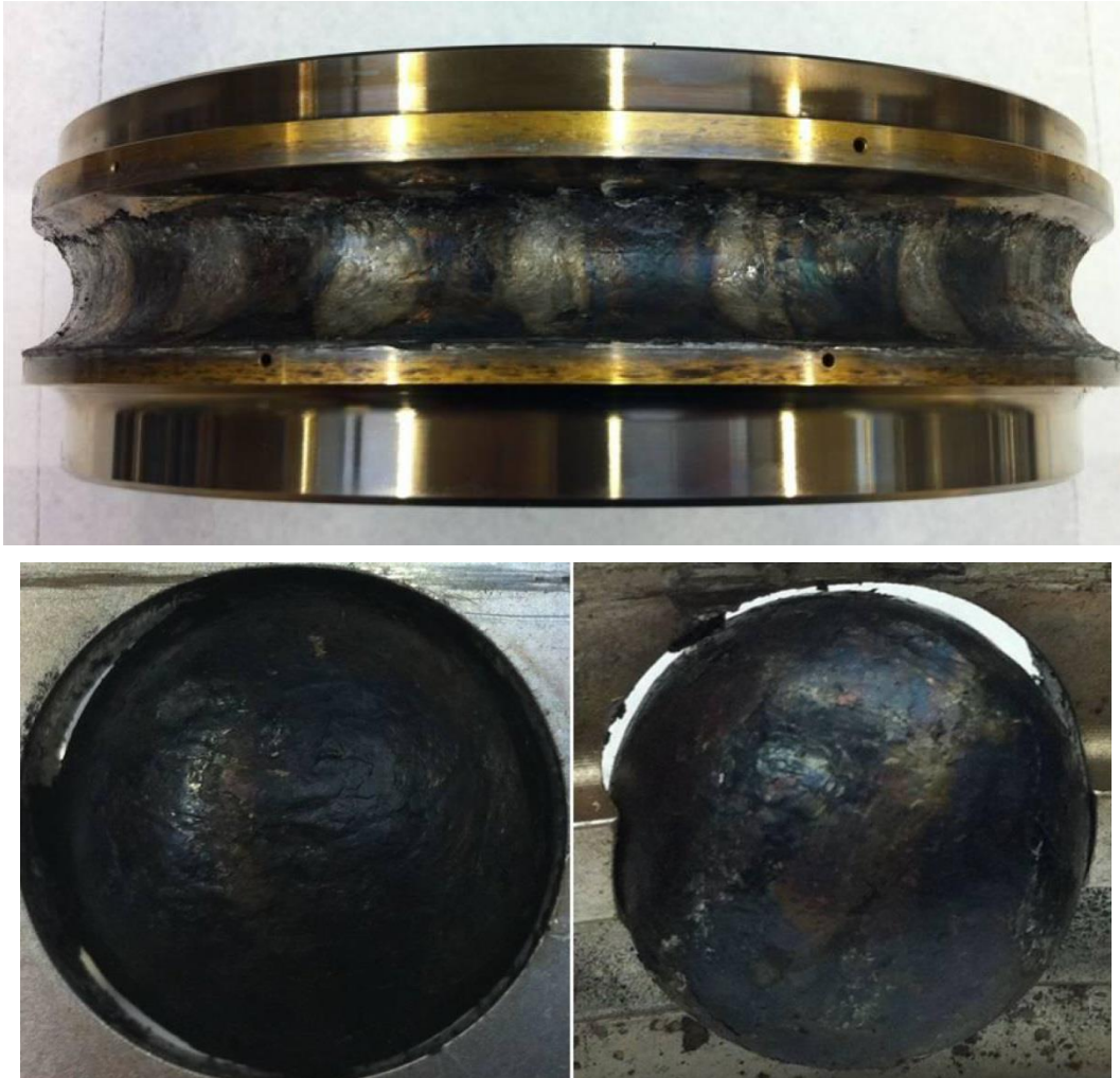
Abbildung 17: Innenring des Stahllagers nach dem erfolgten Versuch mit dem Ausgangszyklus; Oben: die Hälften des geteilten Innenringes sind verschweißt; Unten: Aufschmelzungen an den Kugeln
