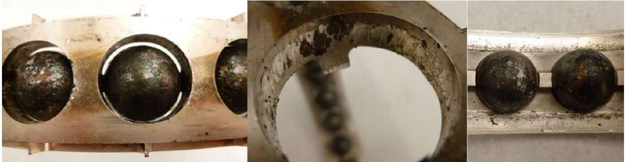
Abbildung 27: Zustand der Stahlkugeln nach dem Versuch „Abgeschnittene Ölzufuhr“ (AP1.5)
