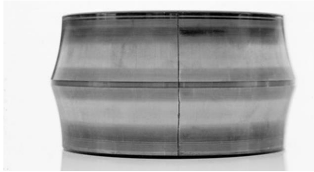
Abbildung 5: Axialer Durchriss des Innenringes eines Pendelrollenlagers – Beispielbild (aus „Wälzlerschäden“, Schaeffler Technologies AG & Co. KG, 2013)
