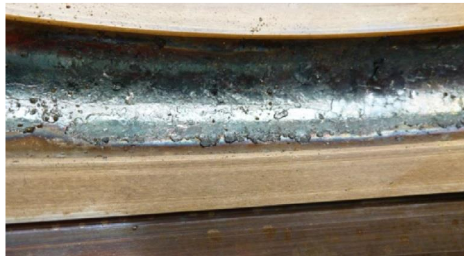
Abbildung 22: Außenringlaufbahn des Hybridlagers mit doppelt gehärteten Ringen nach dem Versuch mit Abschaltung der Ölzufuhr (AP1.5); Es sind großflächige Aufschmelzungen zu erkennen.
