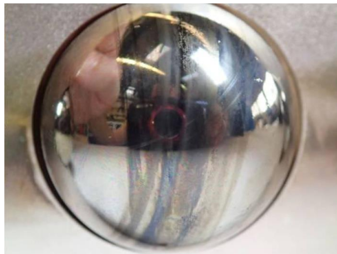
Abbildung 19: Laufspuren und Ablagerungen an der Stahlkugel nach dem Versuch mit Unterbrechung der Ölversorgung (reduzierte Axiallast)
