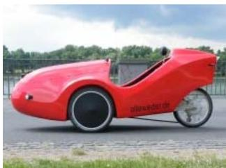
Das Alleweder 6 ist ein verschaltetes dreirädriges Fahrzeug. Die Verschaltung besteht aus Glasfaserverbundmaterial. Im Inneren des Fahrzeuges bleibt der Nutzer von Wettereinflüssen weitestgehend unberührt. Ein weiterer Vorteil dieses Fahrzeuges ist die erhöhte Aerodynamik und die somit erhöhte Geschwindigkeit. Der Schwerpunkt des Fahrzeuges ist aufgrund des eingelassenen Sitzes tief. Das Gewicht des Fahrzeuges beträgt 44 kg. Der Motor befindet sich in der Radnabe.
