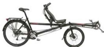
Das Pino ist ein Tandem. Seine Besonderheit besteht darin, dass der vordere Nutzer halb waagrecht fährt. Damit geht dieses Fahrzeug auf unterschiedliche Fahrvorlieben ein. Es besitzt eine Klappfunktion und kann somit besser verstaut werden. Das Fahrzeug besitzt einen Gepäckträger hinter dem aufrecht sitzenden Nutzer. Der Antrieb befindet sich in der hinteren Radnabe. Er wird von der Batterie, welche auf der unteren Querstange befestigt ist, gespeist.
