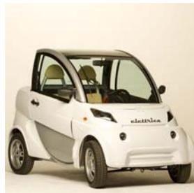
Der Start Lab ist Elektroauto für zwei Insassen. Das Fahrzeug kann zusätzliches Gepäck mit der Masse 230 kg transportieren. Durch den an der Hinterachse angreifenden Antrieb können mit dem Start Lab bis zu 80 km zurück gelegt werden. Die Höchstgeschwindigkeit beträgt dabei 65 km/h.
