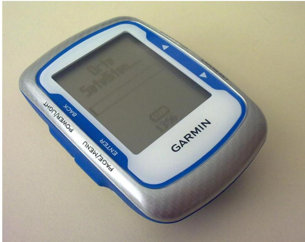
Durch einen GPS-Empfänger und einen barometrischen Höhensensor werden aktuelle Position, Höhe, Geschwindigkeit und Distanz der zurückgelegten Strecke berechnet, angezeigt und im Gerät gespeichert.
