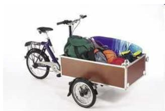
Das Traffic ist ein Lastenfahrrad. Es zeichnet sich durch die breite Lastkiste direkt über den beiden Vorderrädern aus. Mit diesem Fahrrad können 280 kg Gepäck transportiert werden. Das Leergewicht beträgt 45 kg. Es erfolgt eine Motorunterstützung bis 20 km/h.
