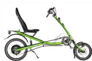
Das ScooterBike ist ein Fahrrad mit tiefem Schwerpunkt. Der typische Fahrradsattel wurde hierbei durch einen Sitz mit Rückenlehne ersetzt. Die Sitzposition ist eher liegend als aufrecht sitzend. Sitz und Lenker sind verstellbar. Das Fahrrad besitzt einen Motor im Hinterrad. Zudem ist hinter dem Sitz eine kleine Ladefläche angebracht.
