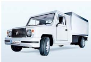
Bei dem EcoCarrier handelt es sich um einen Transporter mit 1800 Liter Gepäckraum und einer zulässigen Zuladelaast von 900 kg. Er beschleunigt von 0 auf 550 km/h in 8,5 s und hat eine Maxmalgeschwindigkeit von 75 km/h. Der Antrieb erfolgt am Heck durch eine Asynchronmaschine.
