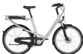
Das Avenue ist durch seine Bauweise für Fahrten auf ebenen asphaltierten Strecken ideal. Es besitzt einen Aluminiumrahmen und wiegt 24,9 kg. Die Batterie ist hinter dem Sattel unter dem Gepäckträger befestigt. Der Antrieb befindet sich in der vorderen Radnabe. Motorunterstützung erhält der Nutzer bis 25 km/h.
