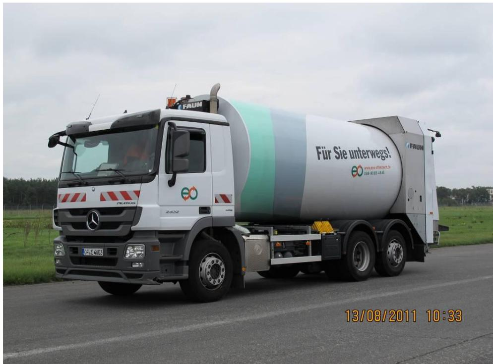
Die Geräuschemissionsquellen beim Standardfahrzeug im Sammelbetrieb sind im Bereich des konventionellen Antriebsstranges, bestehend aus Verbrennungsmotor, Getriebe und Reifen, der Trommeldrehung und der Schüttung auszumachen.
