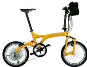
Bei dem Birdy handelt es sich um ein Faltrad, welches sich durch ein geringes Gewicht und, besonders im zusammengeklappten Zustand, geringe Transportmaße auszeichnet. Das Birdy wiegt 18,4 kg und ist mit seiner Klappmöglichkeit besonders als Fahrrad für Kurzstrecken ausgelegt. Dies zeigt sich auch an den relativ kleinen Rädern. Der Motor des Fahrzeuges, befindet sich in der hinteren Radnabe. Die Batterie ist an der Lenkstange befestigt. Es gibt keine Transporthalterungen.
