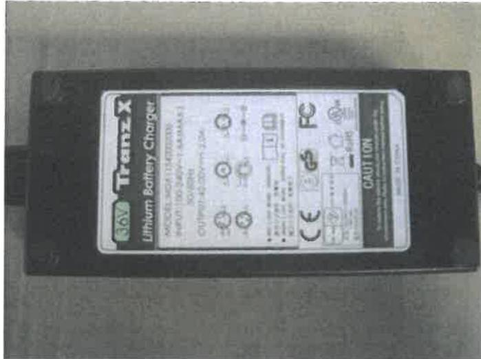
Die Ladegeräte der Riese & Müller-Modelle Jetstream, Birdy und Delite entsprechen des in Abbildung 31 abgebildeten Modells. Bei diesem Modell handelt es sich um ein Ladegerät mit aktiver Kühlung in Form eines Lüfters. Die maximale DC-Leistung beträgt bei den Modellen Jetstream und Birdy 48 Watt und bei den Modellen Delite 74 Watt.
