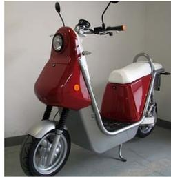
Der Govecs ist ein Elektroroller, dessen Karosserie aus Kunststoff besteht. Sein Motor ist ein bürstenloser Drehstrommotor. Die Höchstgeschwindigkeit des Rollers beträgt 70 km/h.
