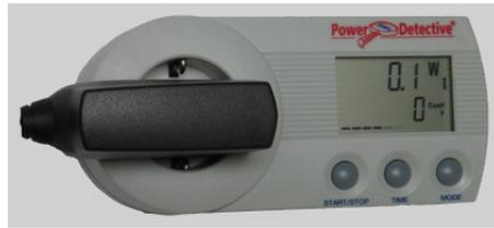
Der AWIS „PowerDetective“-Datenlogger zeichnet weiterhin den momentanen Wert der Stromstärke, der Spannung und des Leistungsfaktors, die über die letzten Messzeitraum gemittelte Leistung, und den Energieverbrauch in kWh auf. Diese Werte werden als csv-Datei auf der SD-Karte hinterlegt.
