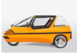
Der City-EL ist ein dreirädriges Fahrzeug, welches eine Person transportieren kann. Er besitzt einen Gepäckraum von 280 Liter. Das zulässige Gesamtgewicht beträgt 400 kg, wobei 140 bis 180 kg Zuladung möglich sind. Die durchschnittliche Reichweite beträgt 60 bis 120 km. Der City-EL besitzt eine maximale Höchstgeschwindigkeit von 63 km/h.
