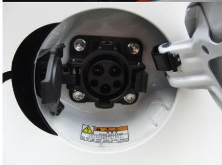
Abbildung 68: Steck-verbinding Ladegerät offboard Schnell-ladung, i MiEV
