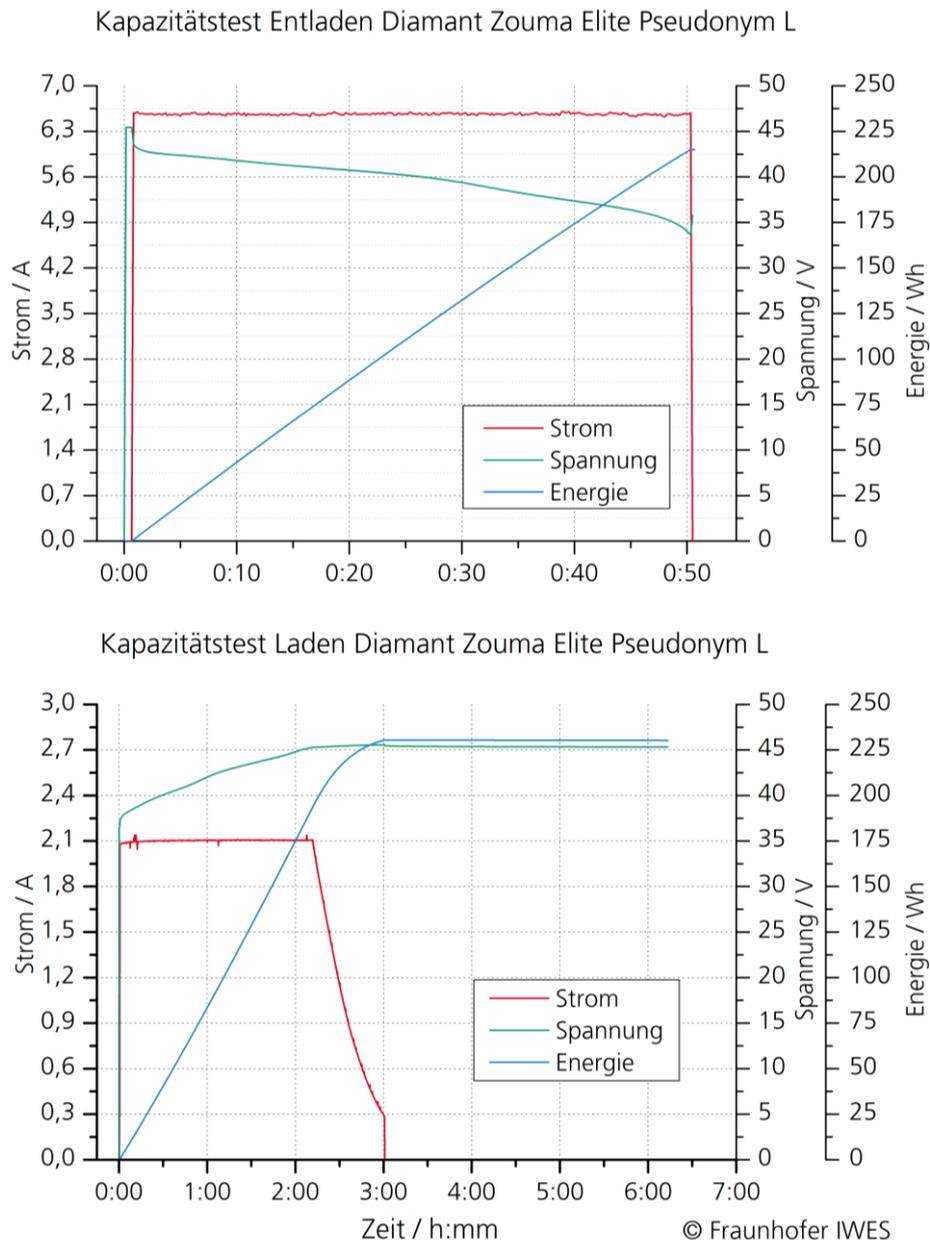
Der Entladetest wurde mit einem Entladestrom von ca. 6,5 A durchgeführt. Der Akku wurde damit nach etwas mehr als 50 Minuten entladen. Es konnten dabei rund 215 Wh aus dem Akku entnommen werden.
