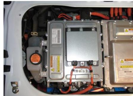
Abbildung 67: Steck-verbinding Ladegerät onboard 230V, i MiEV
