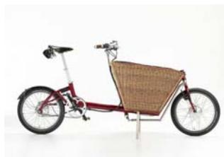
Bei dem Packbernds handelt es sich um ein Lastenfahrzeug. Das Packbernds ist im Vergleich zum Traffic zweirädrig ausgeführt. Die Zuladung kann in einen Korb direkt vor dem Fahrer untergebracht werden. Die Beschränkung für die Zuladung beträgt 260 kg. Der Antrieb des Fahrzeuges befindet sich in der hinteren Radnabe.
