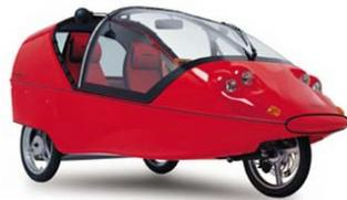
Das Twike ist ein dreirädriges Fahrzeug für 2 Personen. Es bietet einen Stauraum von bis zu 400 Litern. Der Antrieb befindet sich an der Hinterachse. Mit dem Twike können mehr als 200 km zurückgelegt werden. Dabei fährt das Fahrzeug maximal 85 km/h schnell. Es beschleunigt von 0 auf 60 km/h in 9 s.
