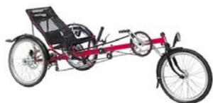
Das Kettwiesel ist ein Liegefahrrad. Der Nutzer nimmt bei diesem Fahrzeug eine sehr tiefe Sitzposition ein. Dies wird durch die verhältnismäßig hoch gelagerten Pedale noch verstärkt. Die Lenkung erfolgt über zwei Hebel an der linken und rechten Seite leicht vor dem Fahrersitz. An diesen sind auch die Bremshebel befestigt. Die Batterie ist hinter dem Fahrersitz angebracht. Das Fahrzeug wiegt im Leerzustand 22 kg.
