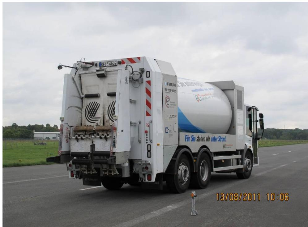
Die Geräuschemissionsquellen beim Hybrid im Sammelbetrieb sind im Bereich der Power-Box (Energieerzeugung durch den Dieselmotor und Verteilung im Hybridbetrieb), des Antriebsstranges (E-Motor, Getriebe, Reifen), des Trommelbetriebes und der Schüttung auszumachen.
