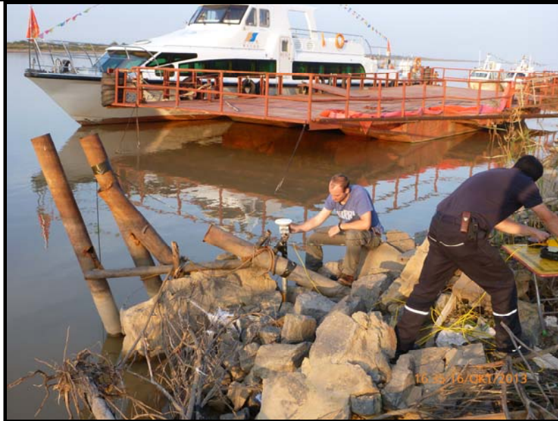
Abb. 1.7 Der Drucksensorpegel am Ufer des Gelben Flusses in der Nähe des Anlegers. Es wurden morgens und abends die gespeicherten Messdaten ausgelesen, qualitätsgeprüft und gesichert.
