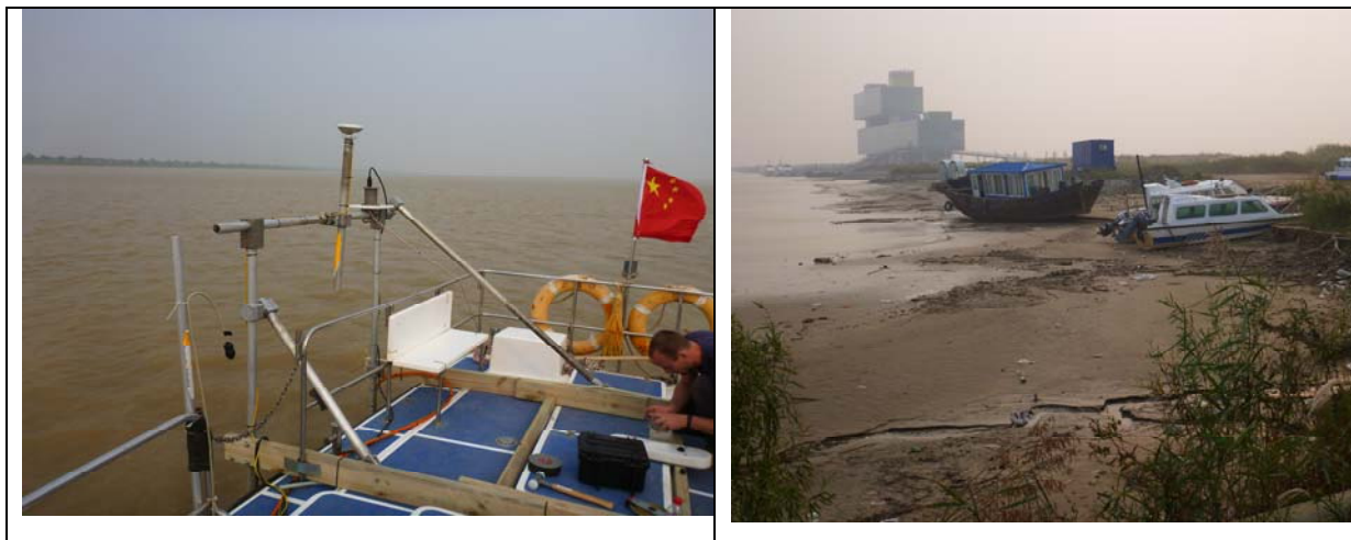
Abb. 1.8 Linke Abbildung: Sensorhalterungen für Multibeam-Echolot, ADCP und GPS. Rechte Abbildung: Beispiele für alternative Vermessungsboote. Im Hintergrund sieht man das Besucherzentrum des Naturschutzgebietes.
