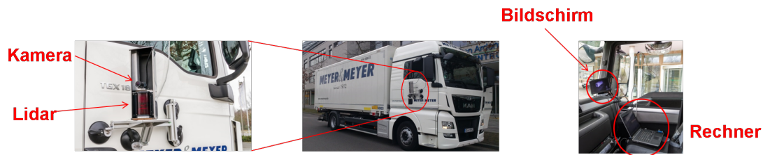
Abbildung 2.1: Hardware-Konfiguration im Abschlusstest. Beide Sensoren werden kompakt durch Saugnäpfe an der rechten Tür des LKWs angebracht (Bild links und Mitte). Die aufgenommenen Daten werden durch einen Rechner in der Fahrerkabine verarbeitet. Das Warnsignal wird durch einen Bildschirm dem LKW-Fahrer gezeigt (Bild rechts).
