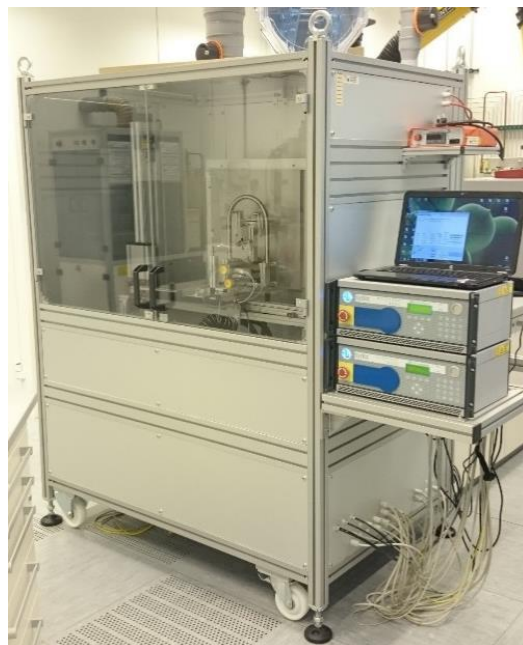
Abbildung 1: Sprühbeschichter im Reinraum der OTH Regensburg
