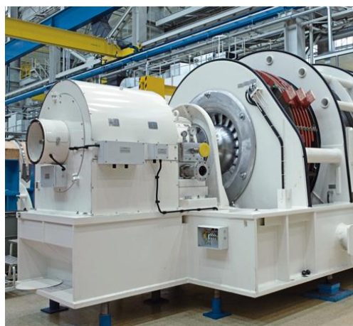
Abbildung 1-2: Zweipoliger Turbogenerator mit bürstenlosem Erregersystem im Siemens Generatorwerk Erfurt [SGen]
