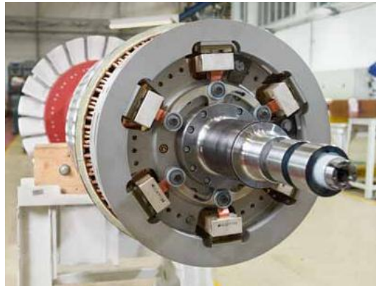
Abbildung 1-3: Rotierender Diodengleichrichter [SGen]
