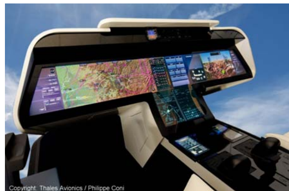
Abbildung 9: Aktuelle und zukunftsweisende Cockpit Display Systeme (links Honeywell EASy II [14] rechts THALES ODICIS Glass Cockpit [15])
