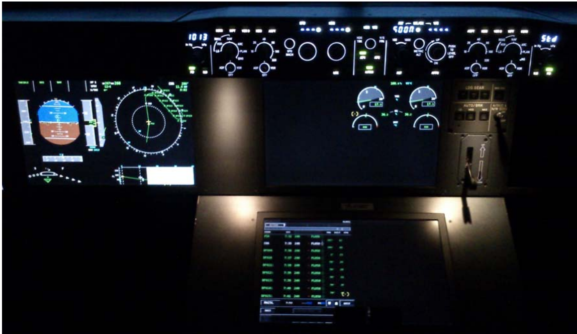
Abbildung 8: Im generischen Experimental-Cockpit integrierte Standard-Avionikanzeigen
