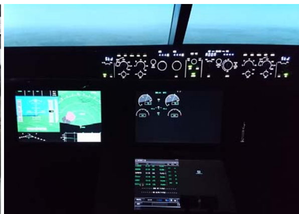
Abbildung 17: GECO mit den auf ARINC 661 implementierten und zu einem SVS erweiterten Avionik-Anzeigen
