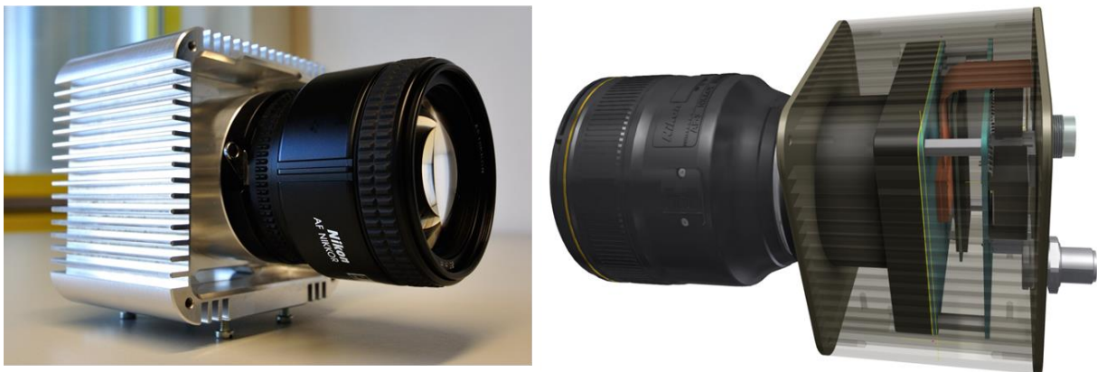
Abbildung 13: Aufgebauter Kamera Prototyp und schematische Darstellung des Kameraaufbaus
