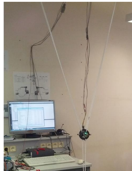
Abbildung 22: Messaufbauten zur Kalibrierung der Inertialen Sensorik
