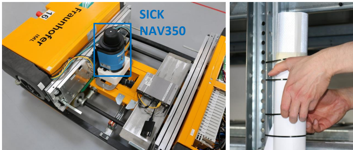
Abbildung 18: SICK NAV350 Navigationslaserscanner als hochgenaue Referenzlokalisierung mittels künstlicher Reflektoren
