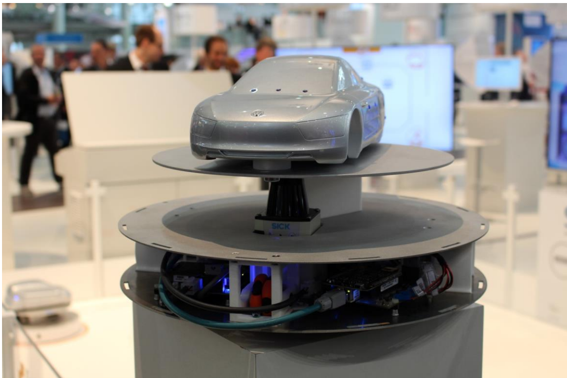
Abbildung 22: Konturbasierte Lokalisierung der Träger- und Versorgungsfahrzeuge im SMART FACE Minidemonstrator
