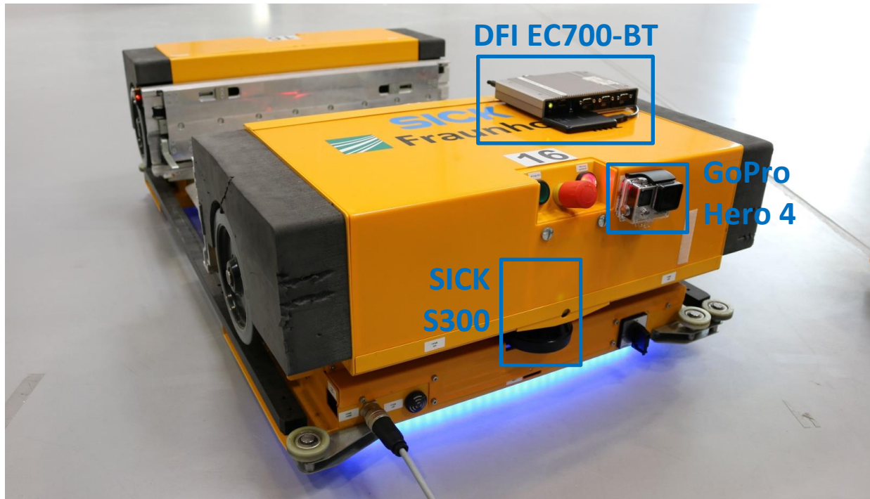
Abbildung 17: Transportfahrzeug mit Konturnavigation auf Basis der vorhandenen Sicherheitssensorik (SICK S300) sowie einer externen Recheneinheit (DFI EC700-BT)
