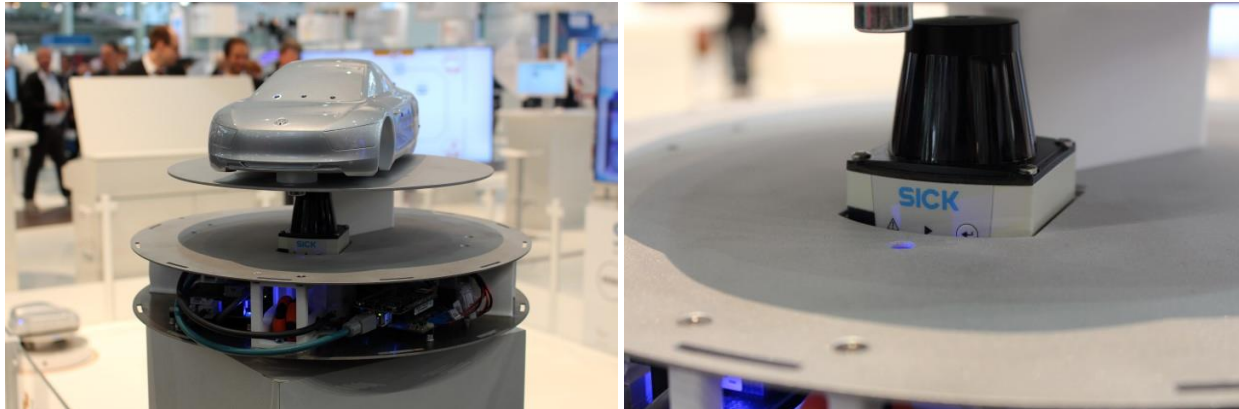
Abbildung 15: Ein SICK TiM5xx, erweitert um die konturbasierte MC-Lokalisierung (rechts), integriert in einem Fahrzeug des Minidemonstrators (links)
