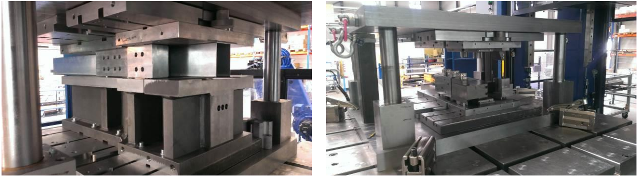
Abbildung 16: Biegewerkzeugeinsätze, links Biegung um die Profilhochachse, rechts Querachse
