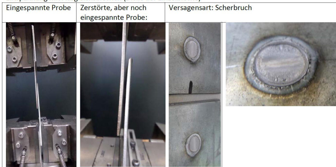
Abbildung 10: Prüfaufbau und Bruchfläche der Schweißpunkte
