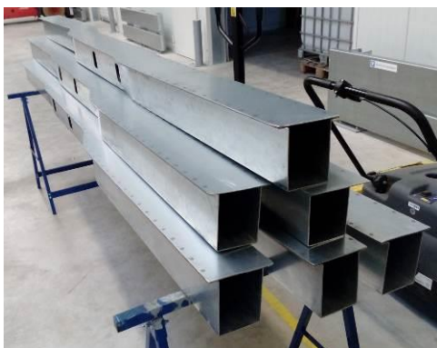
Abbildung 21: Seitwärts gebogene Träger mit mittels Punktschweißen gefügten Deckblechen
