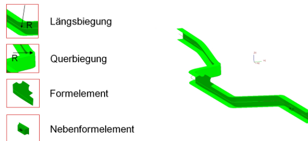
Abbildung 1: Formelemente einer komplexen Längsträgerstruktur [EDAG, UTS]
