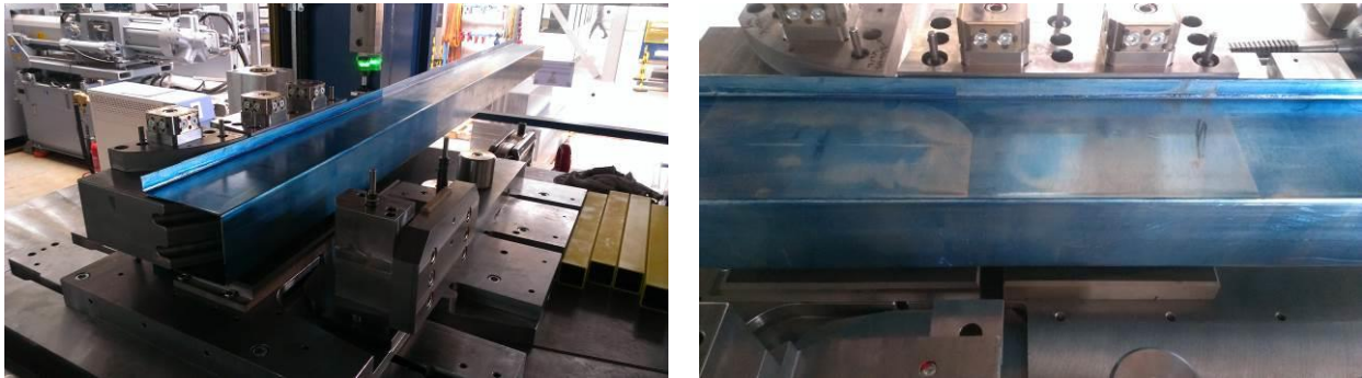
Abbildung 13: Tuschiertes Werkstück im Bauteil (links) und Tragbild nach Klemmlast bei 430 Tonnen, hier Werkzeugeinsatz für die Biegung um die Querachse des Profils
