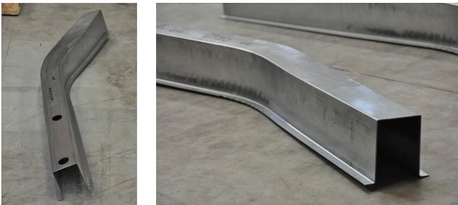
Abbildung 17: Tordierte Biegung (links) und torsionsfreie Biegung (rechts)
