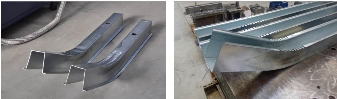
Abbildung 18: Biegung um die Profilquerachse: Flansch im Außenradius mit und ohne Längssicken (links) und Flansch im Innenradius mit Zinnenbeschnitt (rechts)
