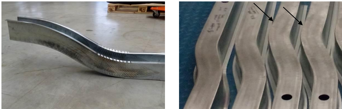
Abbildung 19: S-Biegungen, Querachse (links), Hochachse (rechts) teils mit Gegenbiegung (Pfeile)
