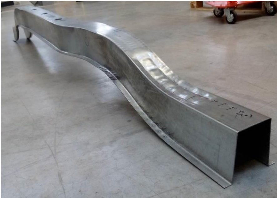
Abbildung 20: Demonstrator als Biege-Rohteil
