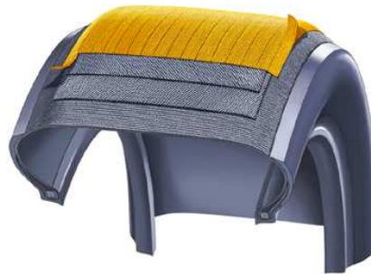
**Abbildung 26.** Farblich hervorgehoben ist die Spulbandage aufgespult auf die Gürtellagen. Die Corde liegen in Umfangsrichtung.
