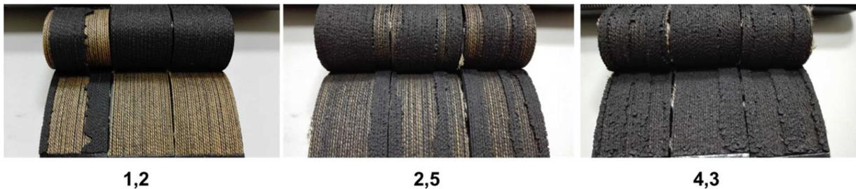
**Abb. 14:** Peeltestprobekörper nach dem Peelttest. Die Werte für die entsprechende Bedeckung stehen unter den Proben.
