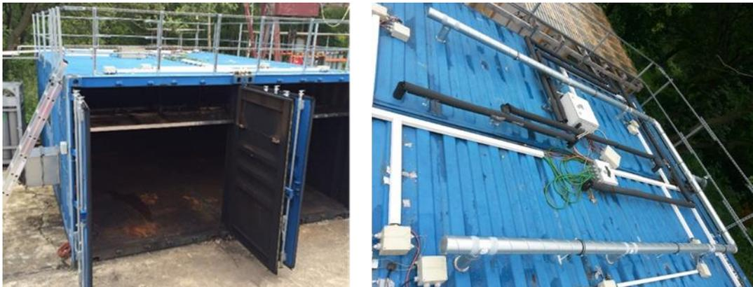
**Abbildung 7-22 Brandcontainer des AOA Brand-/Lösch-Systemteststands**
