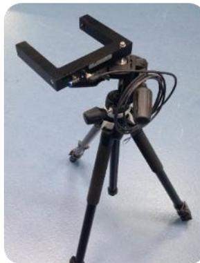
**Abbildung 7-42 Prototyp Lichtdämpfungssensor CAPTRON**
