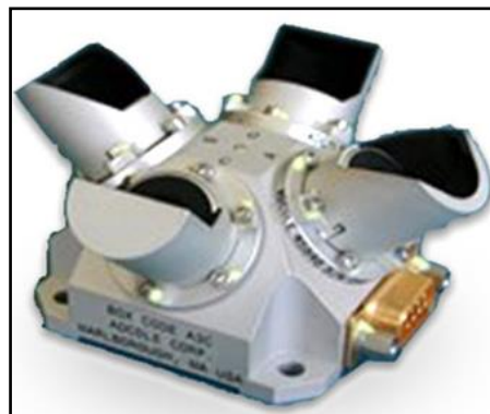
Abbildung 13 Pyramidenartiger Grober Sonnensensor (Verbindlichkeit Adcole)
