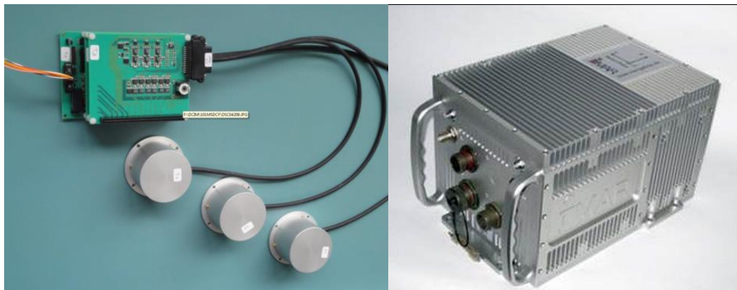
Abbildung 25 Magson Magnetometer (Sensorköpfe und elektrische Einheit) und IMAR IMU (3-Achsen Gyroskop)
