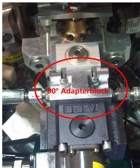
Abbildung 6-13: Aktuator mit Adapterblock (markiert) und Ventil
