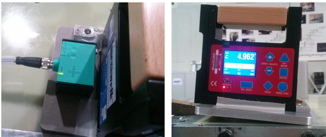
Abbildung 6-46: Inklinometer-Kalibrierung
