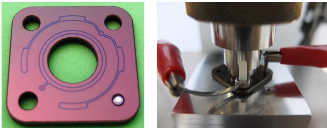
Abbildung 6-51: Fertigestelltes Sensorelement (links) - Test im Labor am Fraunhofer IST zur Aufnahme von Kennlinien (rechts)
