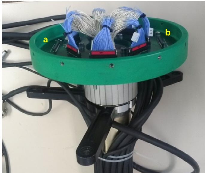
Abbildung 6-37: Schleifring & -platte mit Wellenkabelanschlüssen (a+b)
