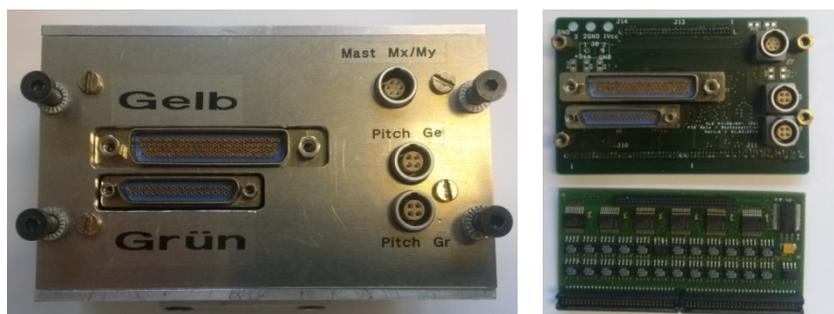
[Abbildung 6-36](#): Verstärkerbox (links), Adapterplatine (o. rechts) und Verstärkerkarte (u. rechts)
