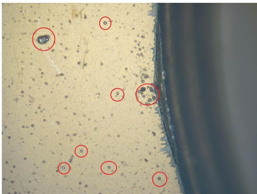
[Abbildung 6-53](#): Fehlerhafte Beschichtung in der Nähe der Kontaktflächen
