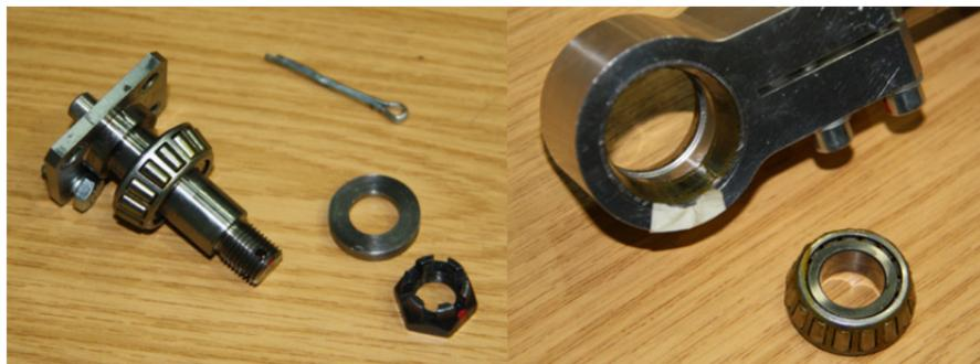
[Abbildung 6-6](#): Lager der äußeren Taumelscheibenaufhängung
