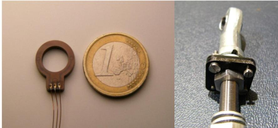
[Abbildung 6-47](#): Kraftmessende Unterlegscheibe auf Dünnschichtsensorbasis (Halbbrücke, Fraunhofer, links), DLR-eigene Applikation an einer Steuerstange (Vollbrücke, rechts)
