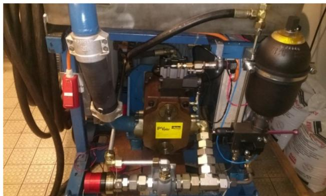
[Abbildung 6-32](#): Neuer Blasenspeicher inkl. Sicherheits-Magnetventil an der Sauer-Hydraulikanlage
