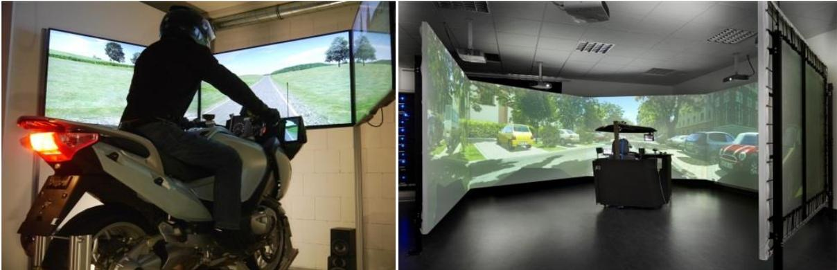
Abbildung 2-1: Motorradfahrsimulator (links) und statischer Pkw-Fahrsimulator (rechts) der vernetzten Motorrad-Pkw-Simulation.
