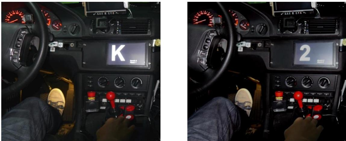
Abbildung 1-4: Umsetzung der Nebenaufgabe im dynamischen Simulator. Links ist ein Distraktor dargestellt, rechts ein Target. Die Probanden wurden instruiert, die weiß markierte Taste zu betätigen, sobald eine Ziffer auf dem Display erschien. Rechts unterhalb der Buchstaben/Ziffern wurde die Anzahl korrekter und falscher Antworten rückgemeldet.
