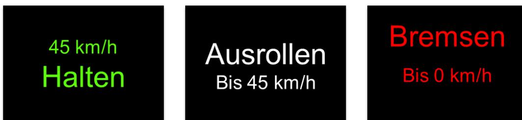
Abbildung 2-9: HMI-Anzeigen des Ampelphasenassistenten.
