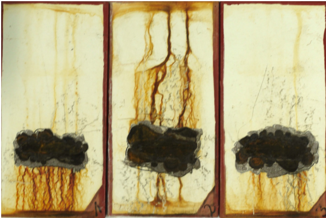
Abbildung 6: Proben nur mit Lacksystem nach dem Zyklustest
