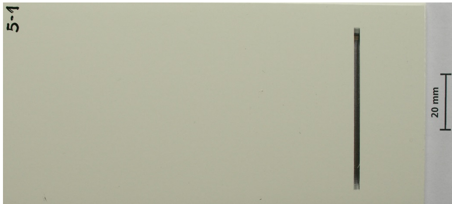
Abbildung 4: Probe mit eingebrachter Fehlstelle
