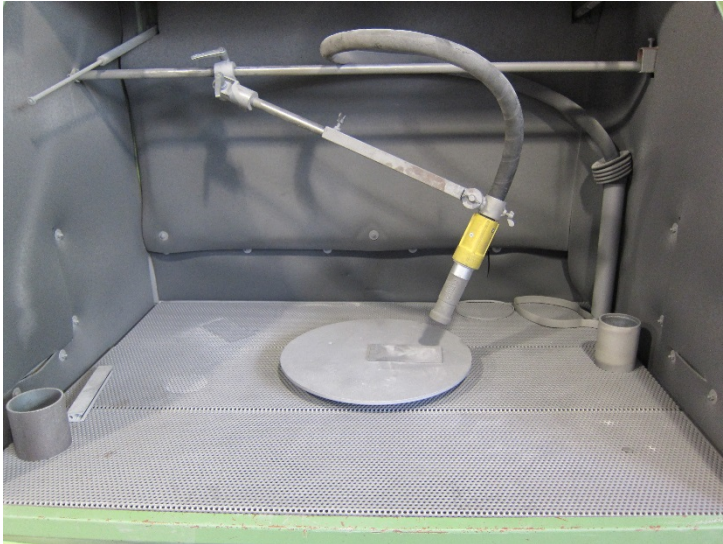
Abbildung 2: Aufbau der Strahlversuche
