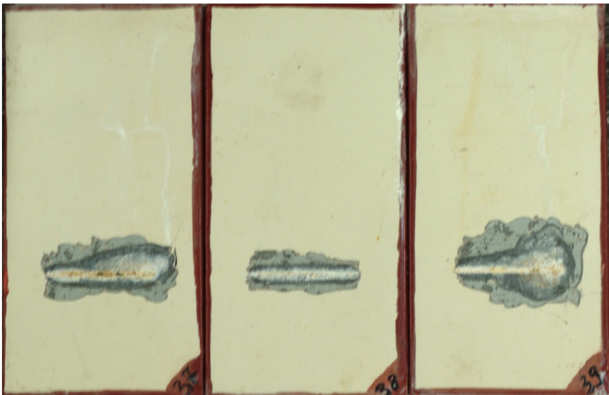
Abbildung 5: Proben mit thermisch gespritztem ZnAl15 nach der Zyklusprüfung
