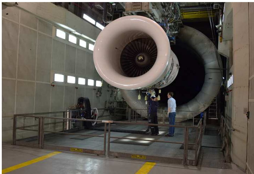
Bild 1: LHT-Prüfstand mit eingebautem Triebwerk; im Hintergrund der Abluftkanal.
