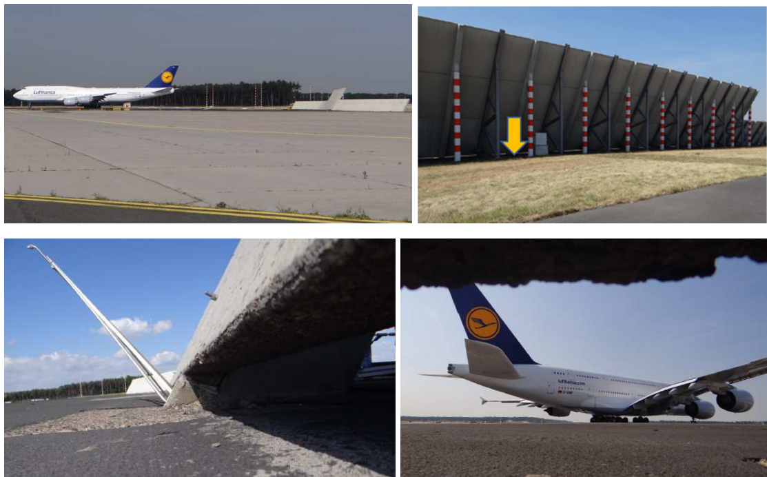
Bild 3: oben links: Blastwand (rechts) am nördlichen Ende der Startbahn 18 West am Flughafen Frankfurt; oben rechts: Position des DLR-Messwagens hinter der Wand; unten links: Spalt unter der Wand mit Messsonde des DLR; unten rechts: Blickrichtung der Sonde entlang der Startbahn auf die eindrehenden Flugzeuge.
