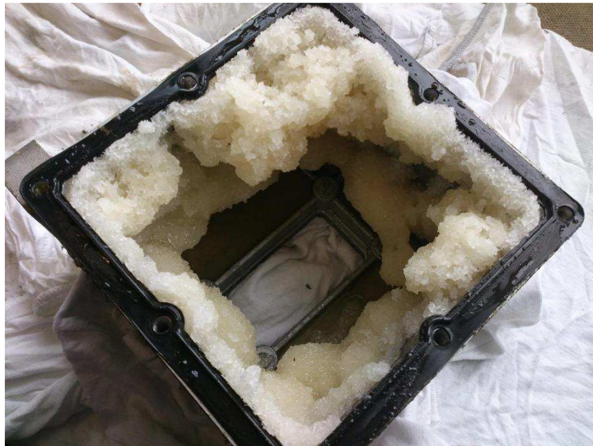
Abb. 12: Kristallisation nicht geeigneter ionischer Flüssigkeit
