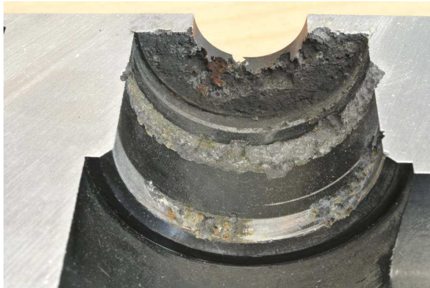
Abb. 13: Korrosion Zylinderkopf Stufe 3
