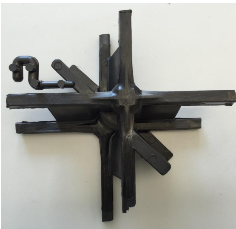
Abbildung 62: Bauteil Erprobung Herstellkonzept Spritzguss
