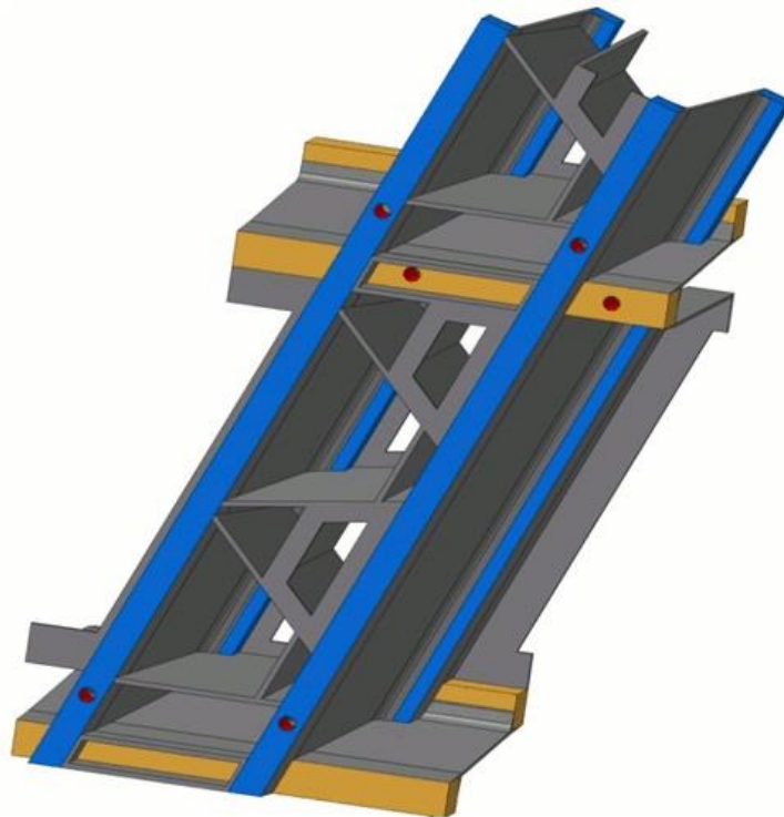
Abbildung 1: Konzeptuntersuchung zur Veranschaulichung der Skelettbauweise.
