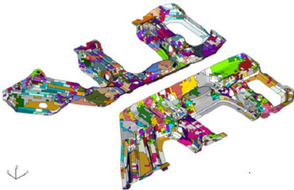
Abbildung 4: Grafische Darstellung einer Bauteiloptimierung an einem CFK-Bauteil. (Quelle: P+Z Engineering)
