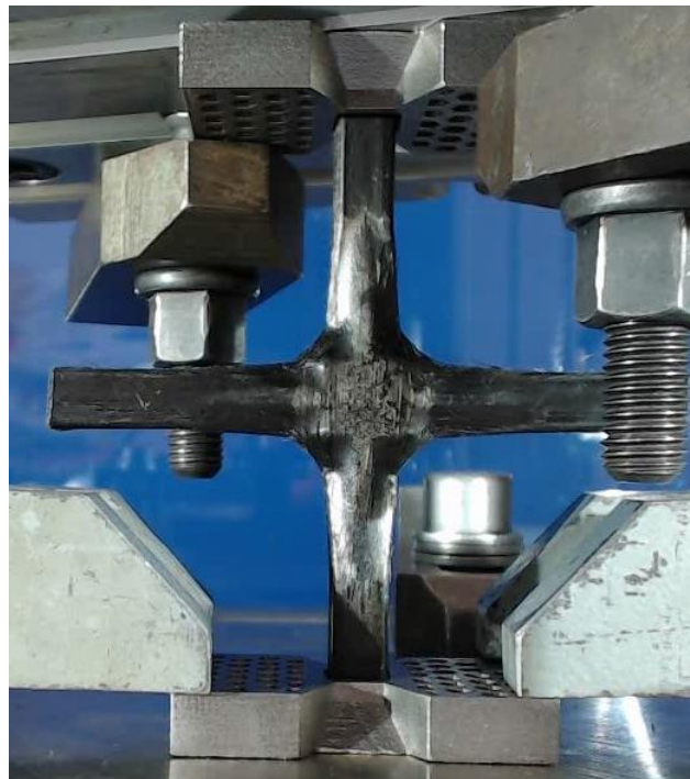
Abbildung 78: Prüfung der Schädigung der Stabverbindung
