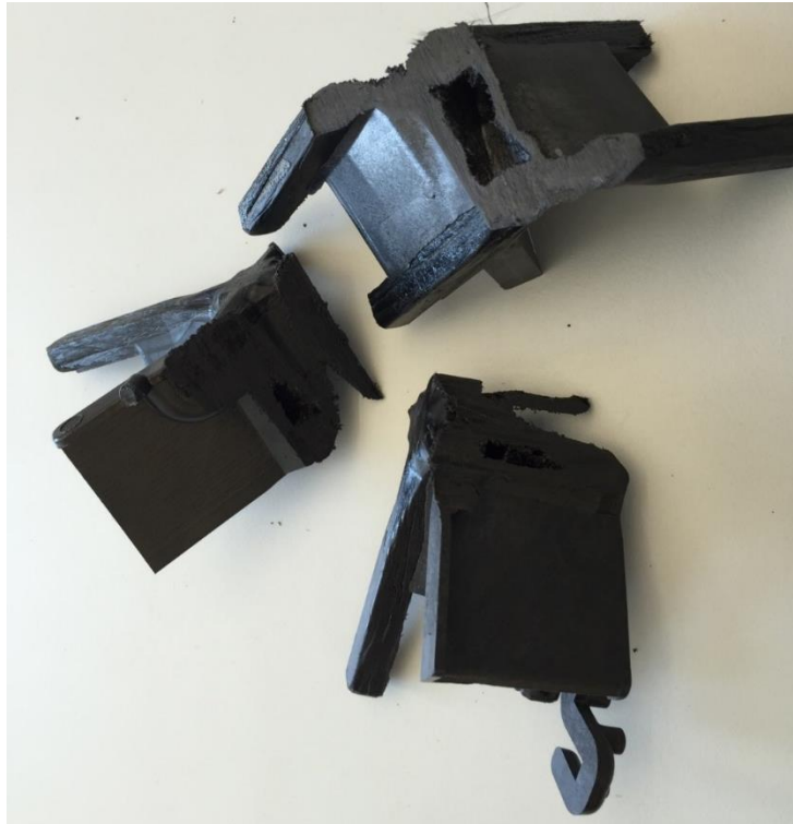
Abbildung 63: Erprobungsbauteil Spritzgussprozess Aufgeschnitten
