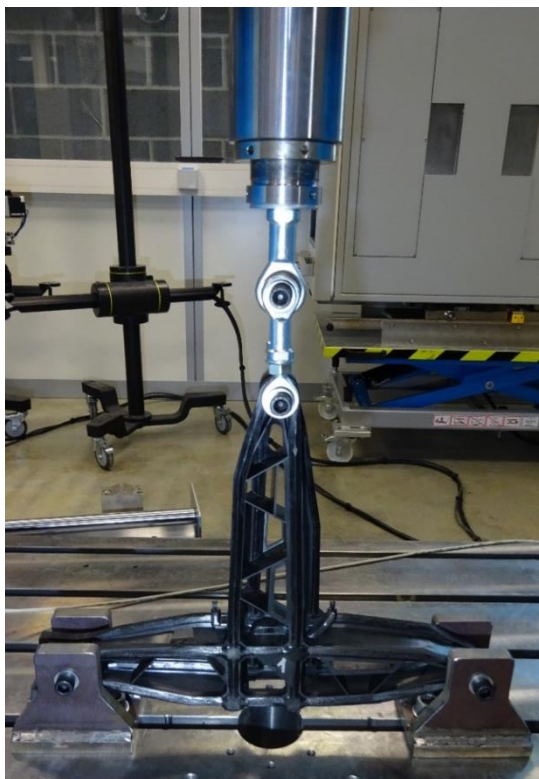
Abbildung 81: Zug- / Druckprüfung T-Träger
