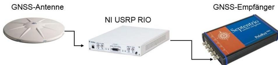
**Abbildung 4-5: Interferenzunterdrückungseinheit ergänzt bestehende GNSS-Systeme mit einer höheren Interferenzrobustheit**
