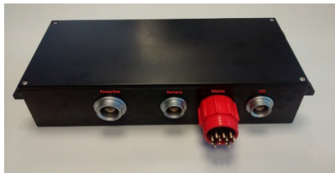
Abbildung 41 - Unterwassereinheit der Telemetrie
