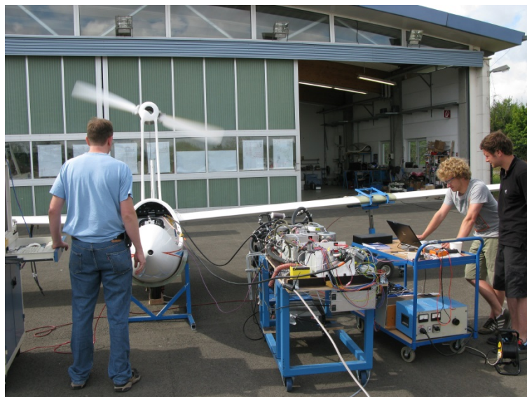
Abbildung 15: Tests des Antriebssystems mit Speisung aus den Brennstoffzellen
