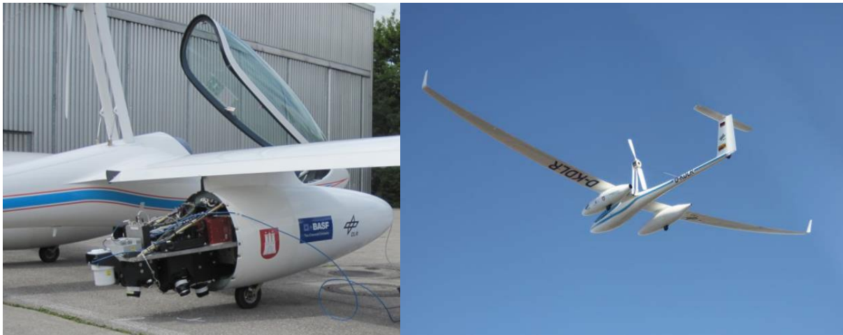
Abbildung 12: Erprobung der Antares H2 mit Erkundungs- und Batteriesystem
