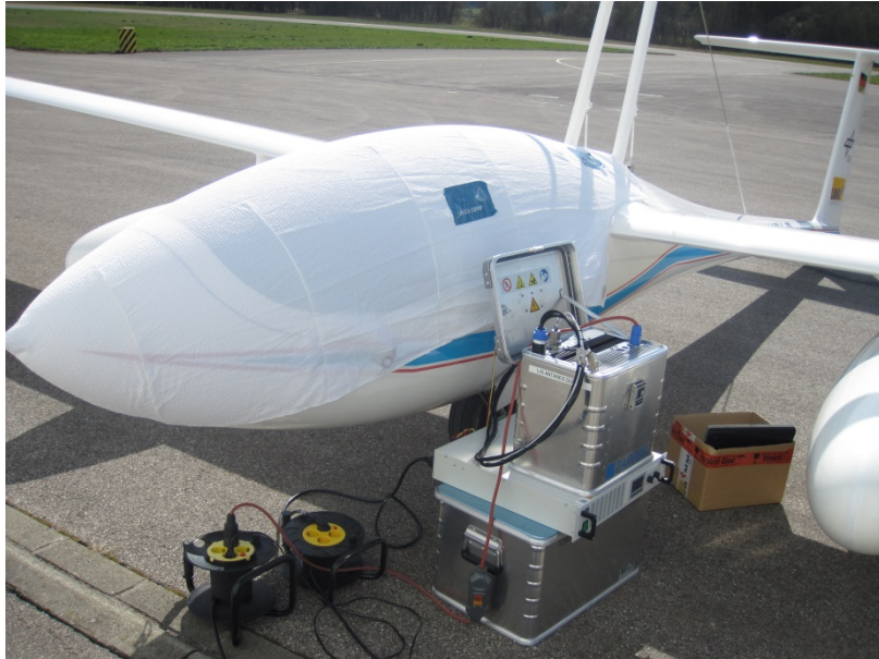
Abbildung 11: Schnellladung der Antares DLR-H2 Batterien mit dem automatischen Ladegerät und einem zusätzlichen Schnellladegerät
