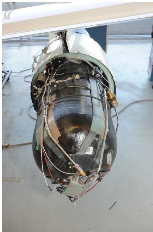
Abbildung 16: Druckbehälter am Flugzeug im Außenlastbehälter angebaut.
