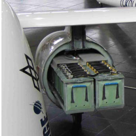
Abbildung 10: Batteriepaket integriert im rechten Außenlastbehälter der Antares DLR-H2
