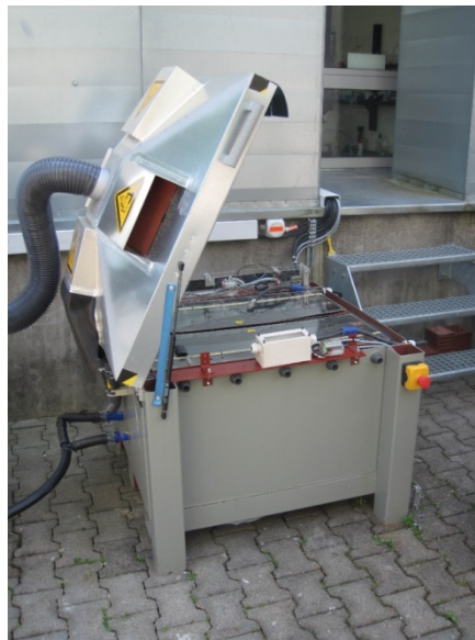
Abbildung 21: Foto des Batteriecontainers zum sicheren Betrieb der Batterie im Hybridteststand
