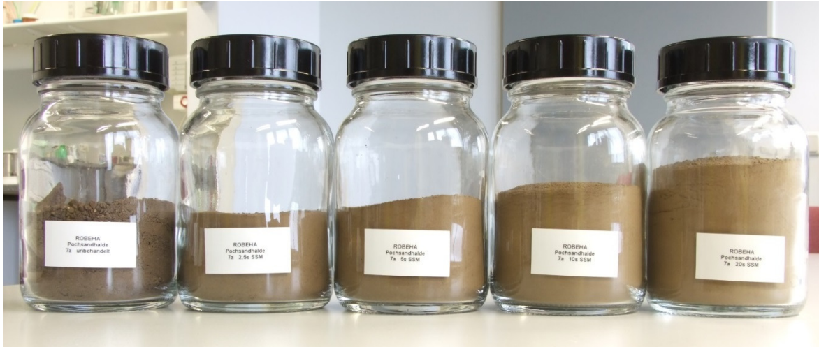
Abbildung 22: Probe 7a: Pochsand, Silbernaal. Von links nach rechts: ungemahlen; 2,5s; 5s; 10s; 20s gemahlen mit Scheibenschwingmühle.
