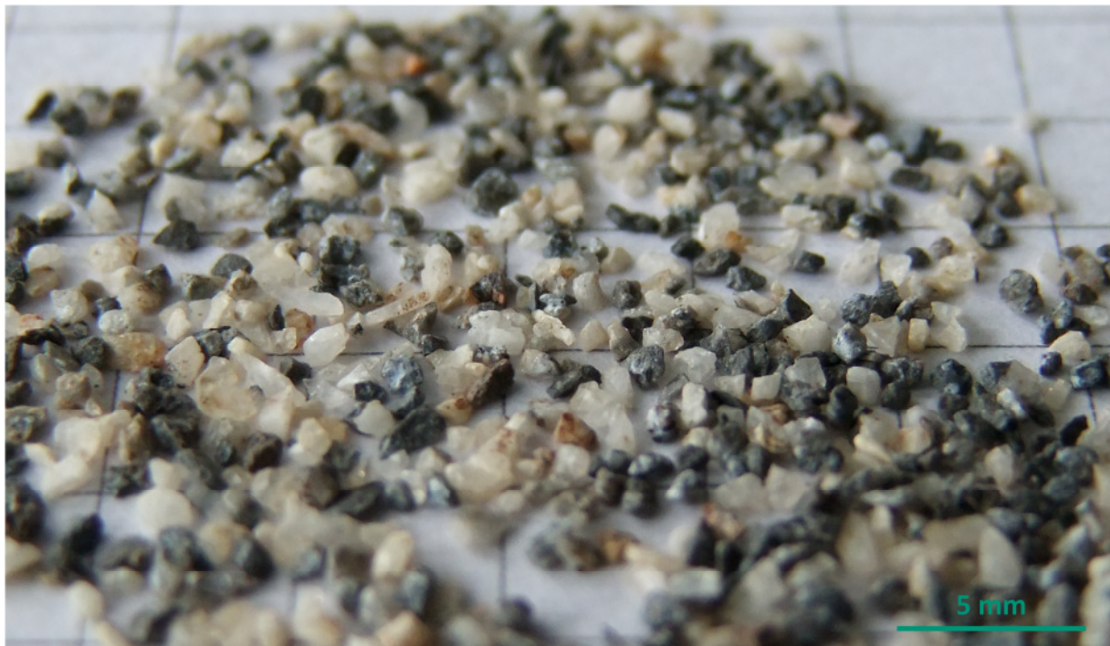
Abbildung 29: Exemplarisches digitales Foto einer Siebfraktion des Materials 5b (Ottiliaeschacht)
