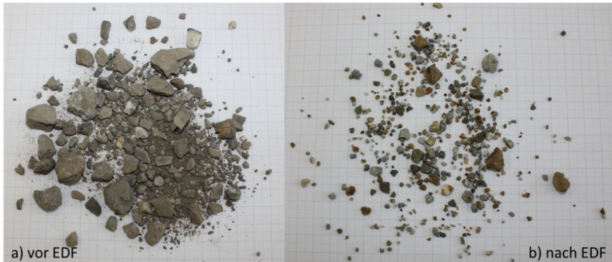
Abbildung 42: Bergematerial vor (a) und nach (b) Elektrodynamischer Fragmentierung (EDF)
