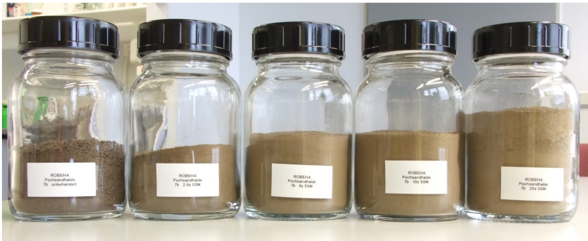
Abbildung 23: Probe 7b: Pochsand, Silbernaal. Von links nach rechts: ungemahlen; 2,5s; 5s; 10s; 20s gemahlen mit Scheibenschwingmühle.
