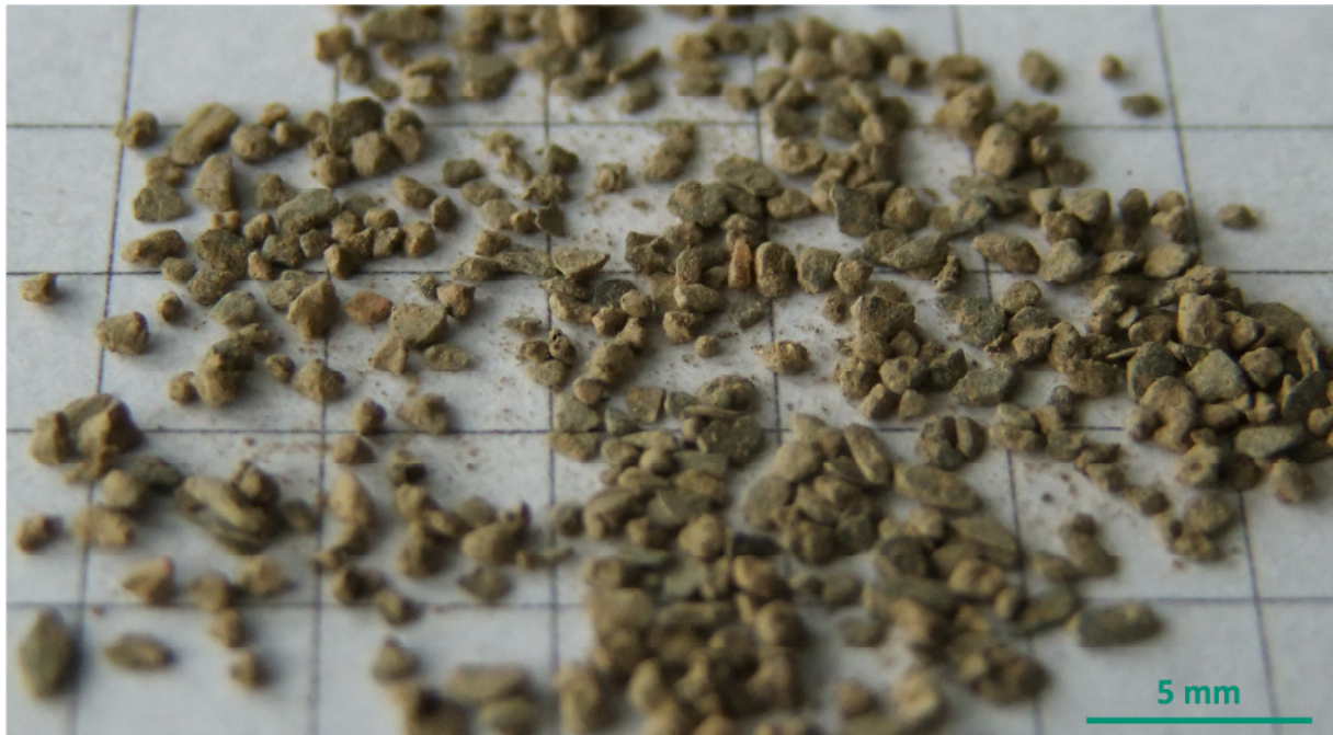
Abbildung 31: Exemplarisches digitales Foto einer Siebfraktion des Materials 4b (Sekundärhalde Rammelsberg)
