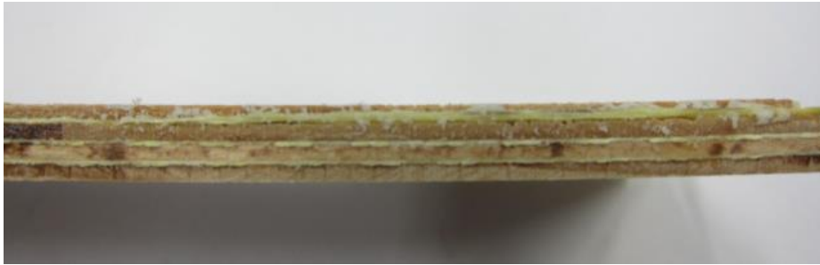
Abbildung 27: Reparatur durch zweilagigen Patch, hier Anbruch durch Aramidgewebe und Zusatzfurnier
