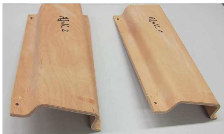
Abbildung 22: Aramidverstärkte Profile nach Torsionsbelastung bis 90° Torsionswinkel
