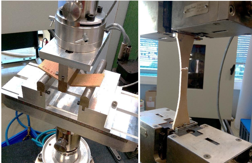
Abbildung 4: Prüfaufbau; links: 3-Punkt-Biegeprüfung in Anlehnung an DIN EN 310; rechts: Zugprüfung in Anlehnung an DIN 52377
