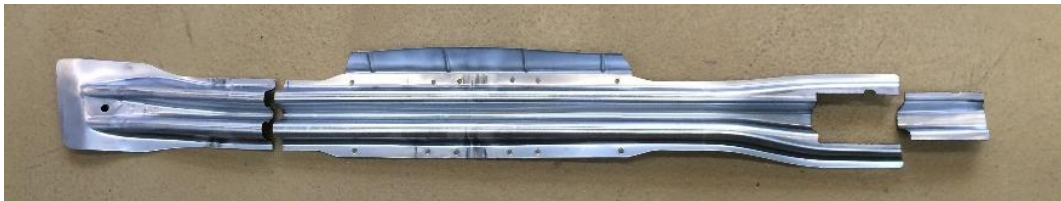
Abbildung 48: Beschnitt der Originalstrebe mittels Laser
