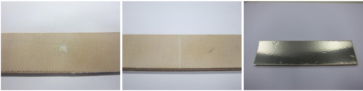
Abbildung 26: Reparatur durch einlagige Patches: Punktierung durch Glasfasergewebe (links), Kerbung durch Glasfasergewebe (Mitte) und Anbruch durch Edelstahlfolie (rechts)
