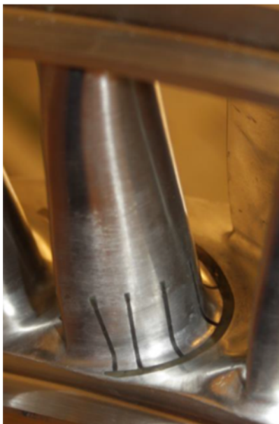
Abbildung 14: Sensoren auf der Saugseite des Rotors auf 20% Kanalhöhe
