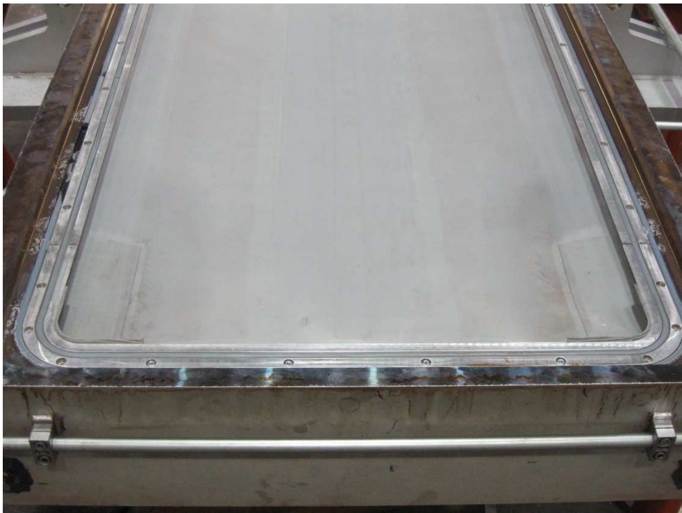
Abb. 49: Druckkoffer mit eingeschraubtem Spannrahmen, Detail
