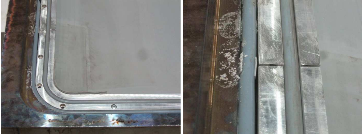
Abbildungen 50 und 51: gestauchter und verzogener Spannrahmen
