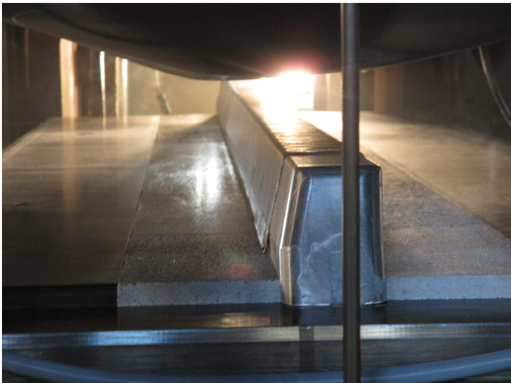
Abbildung 46: Fertig gepresster Spar auf der Unterform
