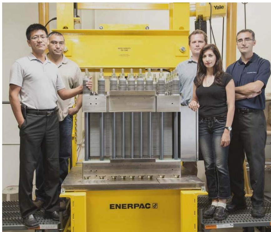
Abbildung 92: 1 MW PEM Stack fertig assembliert
