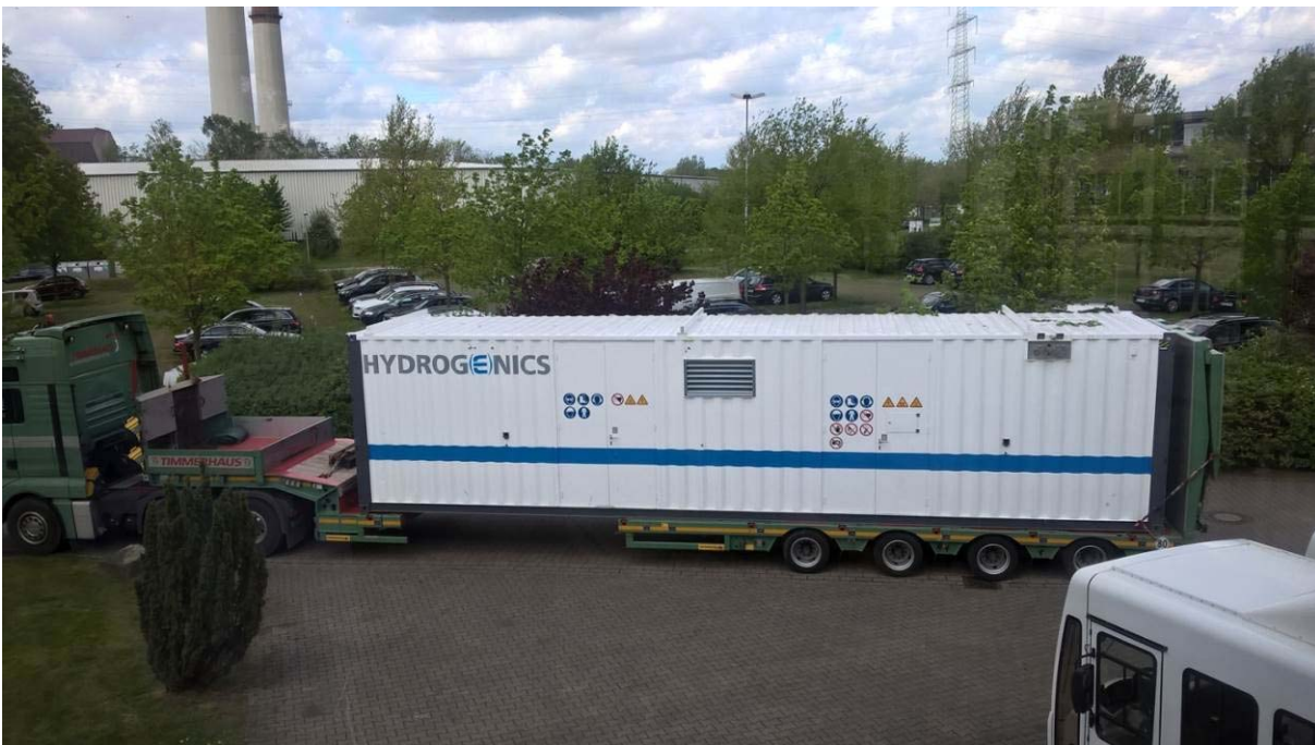
Abbildung 105: Transport der 1MW Elektrolyseanlage von Gladbeck nach Hamburg nach Werksabnahme
