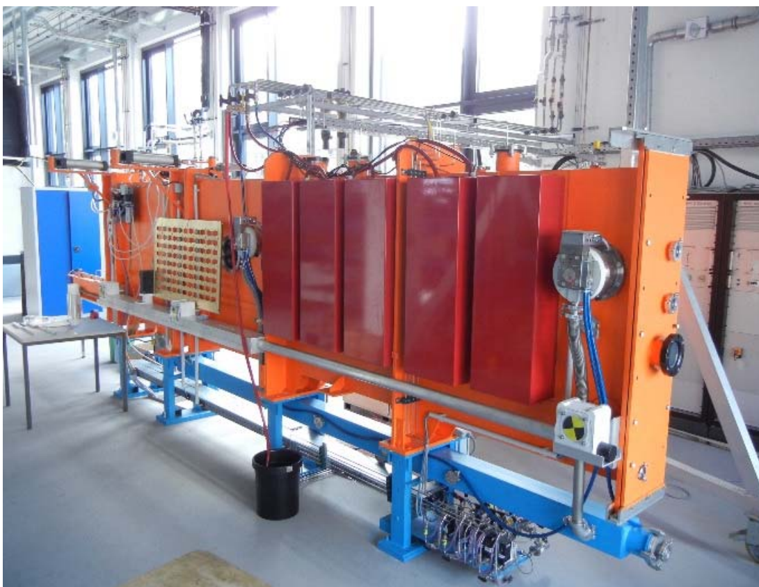
Abbildung 32: Vertikale Sputteranlage am Fraunhofer ISE
