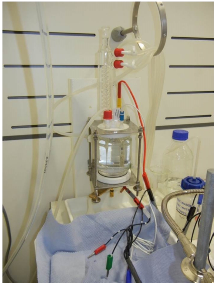
Abbildung 27: Messzellen für die elektrochemischen Messungen bei Raumtemperatur (links) und bei 80°C (rechts).
