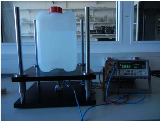
Abbildung 28: Messvorrichtung für die Bestimmung des Kontaktwiderstands (links: Gesamtansicht mit Gewicht und 4-Punkt-Spannungsmessgerät, rechts: Detail einer Bipolarplatte in Kontakt mit einem Karbonvlies zwischen zwei vergoldeten Zylindern).
