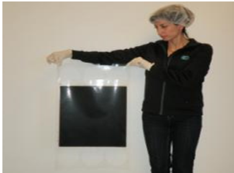
Abbildung 90: MEA in finaler Größe, sowohl für Kurz-Stack als auch für 1 MW Stack verbaut
