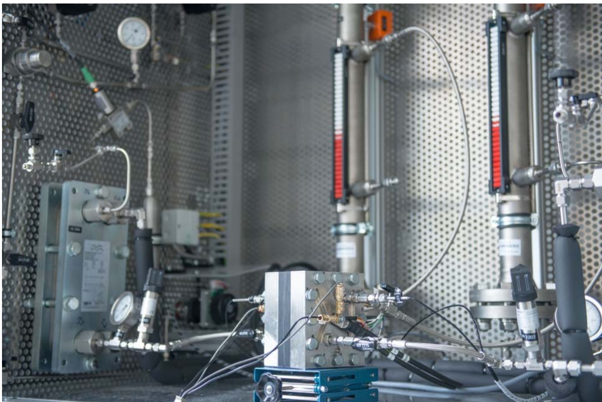
Abbildung 15: Teststand für Einzelzellen am Fraunhofer ISE für Kurz- und Langzeitcharakterisierung
