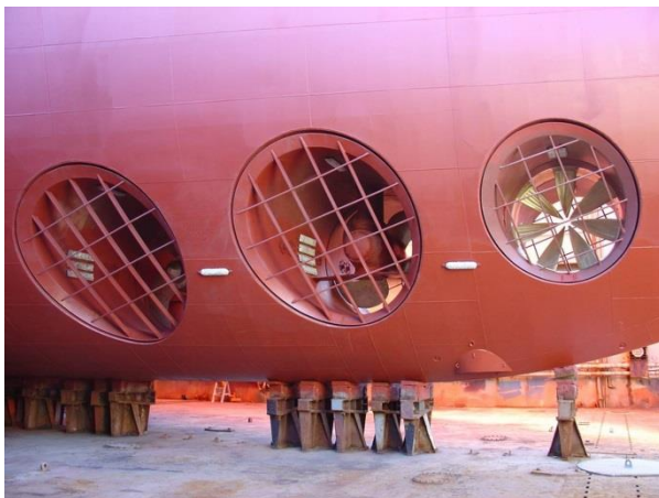
Abbildung 21: Anordnung der Bugstrahler beim Offshore-Versorger (SVA Modell Nr. M1600)
