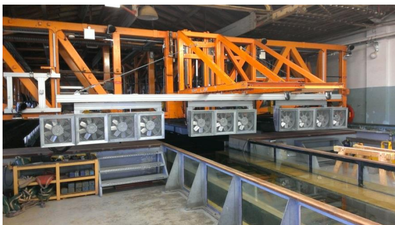
Abbildung 6: Installierte Windanlage in der Schlepprinne der SVA
