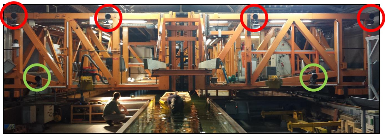
Abbildung 15: Überführung des Positions-/Beschleunigungsbestimmungssystems in den Versuchsbetrieb
