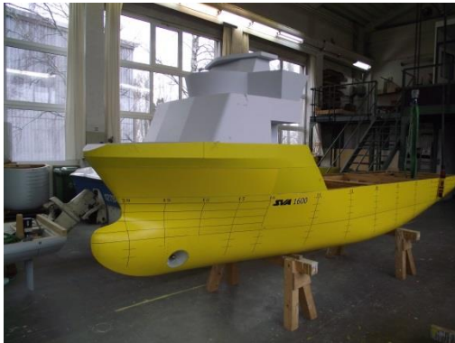
Abbildung 20: Modell des Offshore-Versorgers (SVA Modell Nr. M1600) mit Aufbauten
