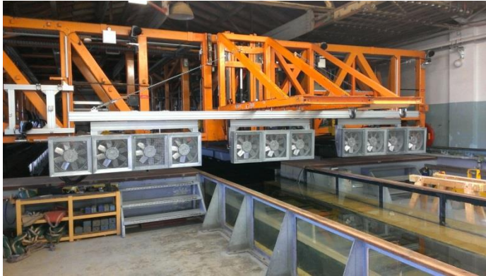
Abbildung 13: Installierte Windanlage in der Schlepprinne der SVA
