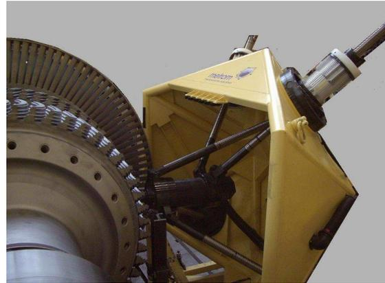
Abbildung 1.4: Mobile Maschine: Grundgestell in Bearbeitungsposition (vertikale Aufstellung ohne Anpassgestell).
