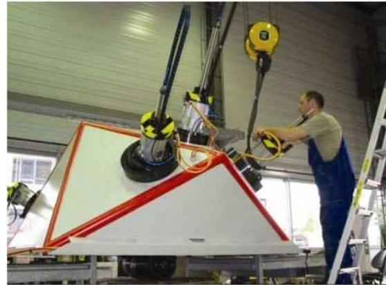
Abbildung 1.1: Parallelkinematik bei der Abbildung 1.2: Montage einer 5-Achs-Highspeed-Bearbeitung von Aluminium: gut Kinematik als verfahrbares Maschinen- zu erkennen sind die Antriebsachsen auf Basis Grundelement und Vorläufer der Mobilen Maschine von Kugelumlaufspindeln.
