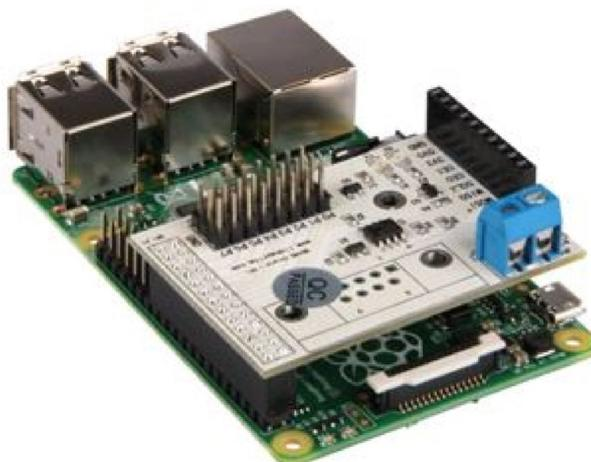
Abbildung 2.11: Raspberry Pi mit Erweiterungsplatine für RS-485
