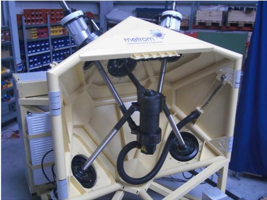
Abbildung 1.3: Mobile Maschine: Grundgestell in Transportposition
