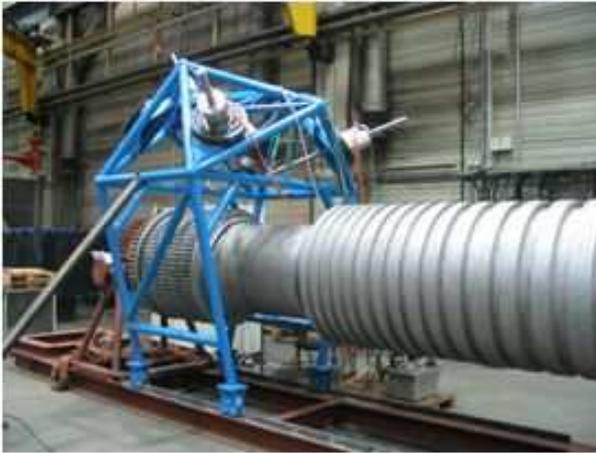
Abbildung 1.5: Prototyp einer von ihrem Anpassgestell versteiften Maschine.
