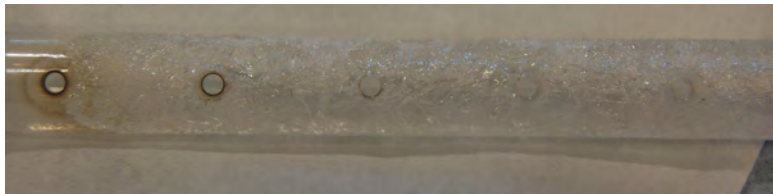
Abbildung 2.21: Fotografie des gebrauchten, ursprünglichen Mini-Showerheads. Gaseinlass auf der linken Seite.
