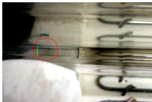
Abbildung 2.17: Ferrocen-Zuleitung (inneres Rohr) mit zersetztem Ferrocen (roter Kreis) und Trennstelle (grün). Mischzone mit HCl rechts vom Ende der Ferrocenzuleitung.
