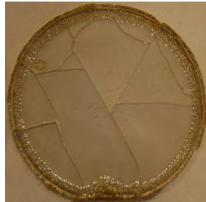
Abbildung 2.9: Freistehendes GaN, MOVPE-Facelo-Prozess, 1 mm Schichtdicke.
