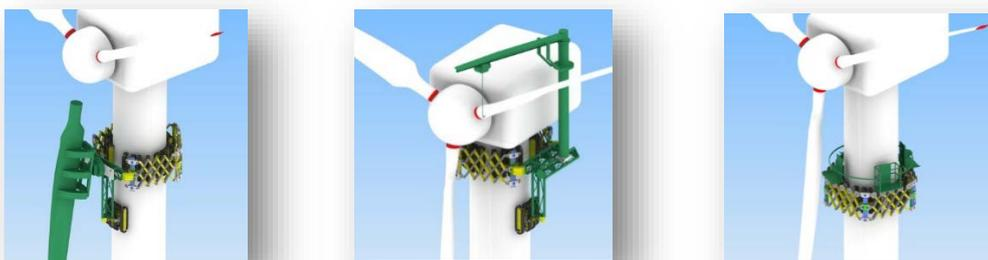
Abbildung 3: Konzeptentwicklung basierend auf Kettenfahrwerken
