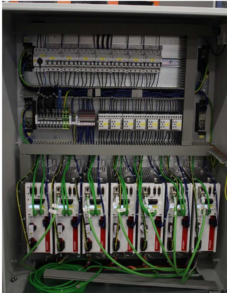
**Abbildung 45: Schaltschrank S2 (Servoverstärker)**
