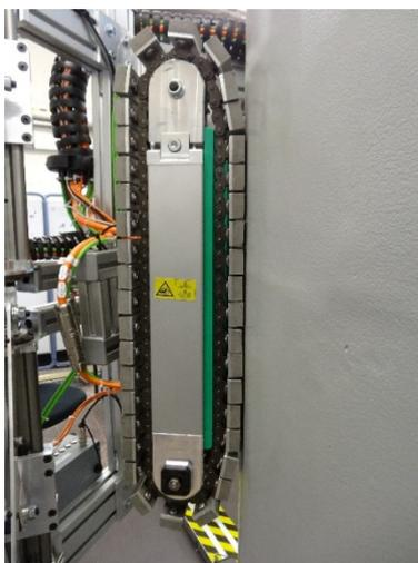
Abbildung 41: Kettenfahrwerk mit Warnhinweis
