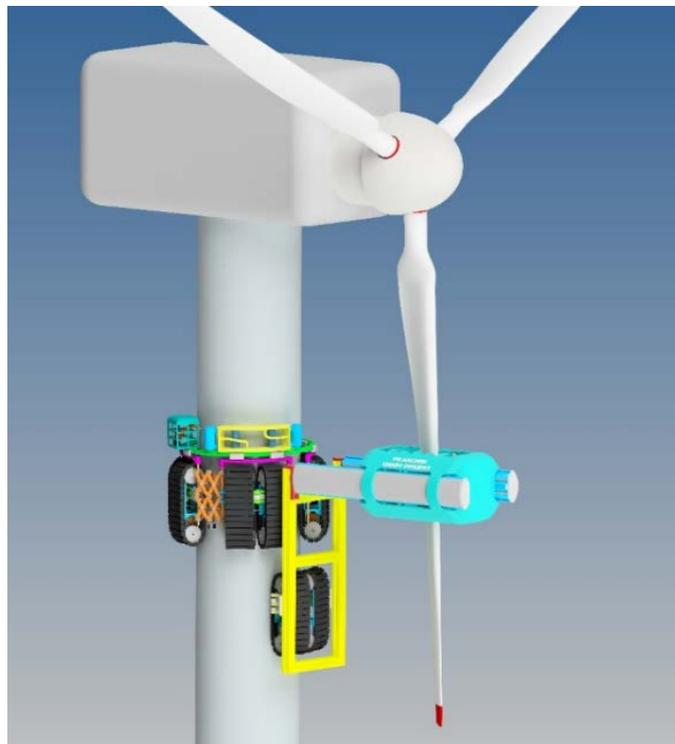
Abbildung 1: Turm-Kletterroboter für Windenergieanlagen
