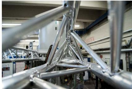
**Abbildung 42: Dreipunkt-Aluminiumprofilfachwerk-Ausleger**
