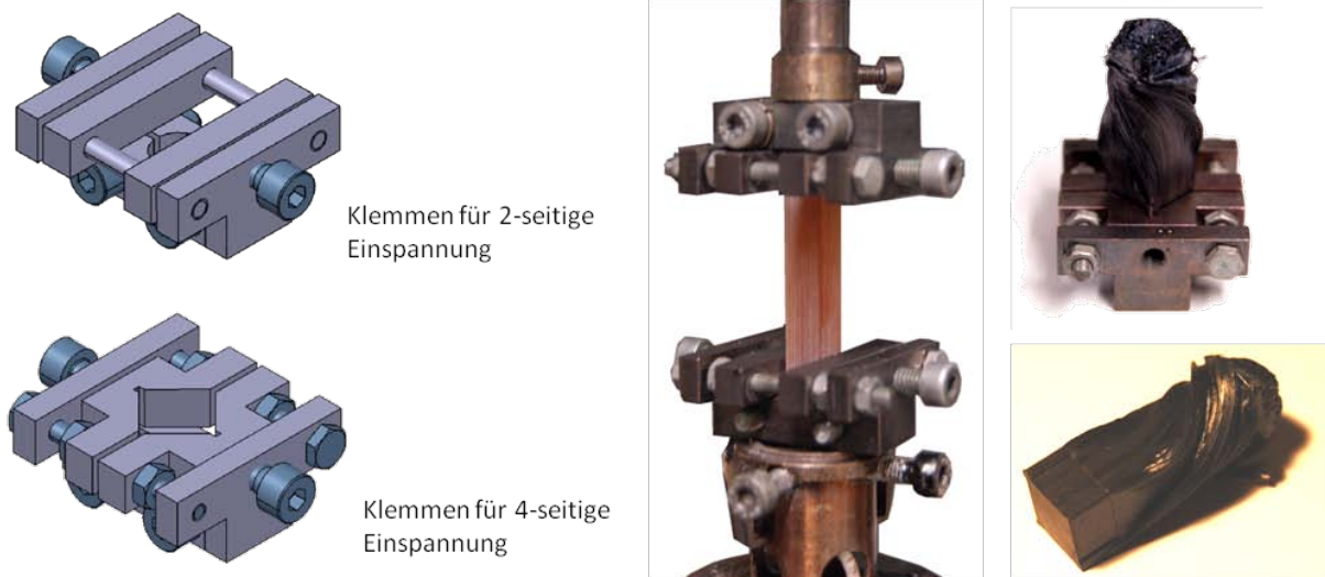
Abbildung 78: Probenhalter für den Schubtest im Rheometer
