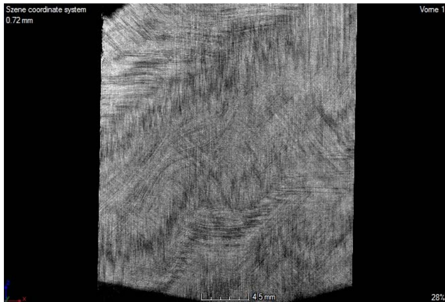
Abbildung 109: Prüfkörper ZA - Faserwelligkeiten
