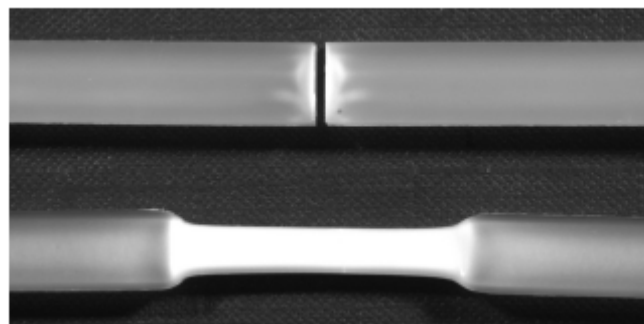
Abbildung 63: Deformationsverhalten an der Bindaht eines Formteils aus nukleiertem und nicht nukleiertem Polypropylen (PP), (Achim Frick, 2006)
