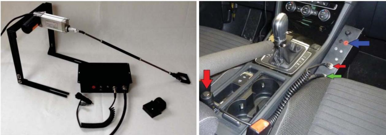
Abbildung 10: Ausführung Wählhebel-Aktuatorik
