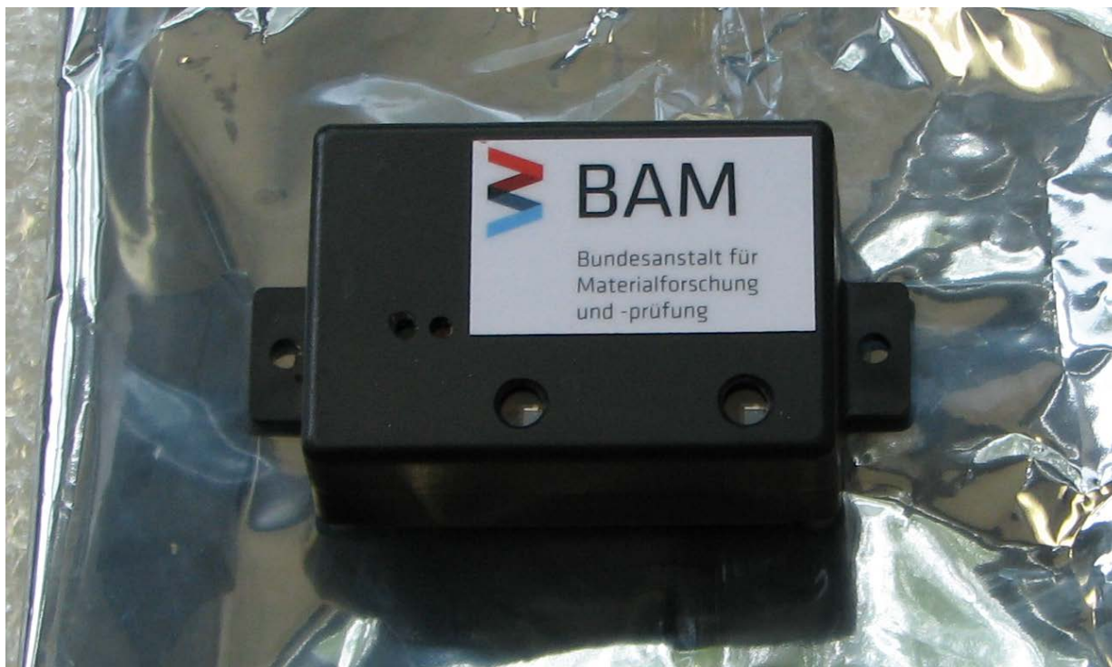
Abbildung 29 Das Funktionsmuster der aktiven Variante des Röntgen- und Tageslichtsensors.
