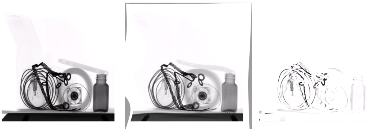
Abbildung 37 Beide Durchstrahlungsaufnahmen nach erfolgter B-Spline Deformation. Rechts das resultierende Differenzbild.
