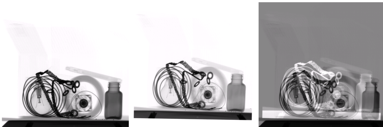
Abbildung 31 Zwei Durchstrahlungsaufnahmen des gleichen Packstückes (links und mittig). Bei der zweiten Aufnahme wurde das Packstück sowohl in der Höhenlage verändert als auch um 10 Grad in der horizontalen und 2 Grad in der vertikalen Richtung verdreht. Das resultierende Differenzbild ist rechts wiedergegeben.
