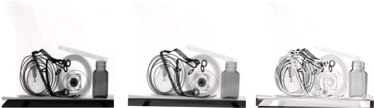
Abbildung 34 Beide Durchstrahlungsaufnahmen im gleichen Koordinatensystem nach der Translation. Rechts ist das sich ergebende Differenzbild gezeigt.
