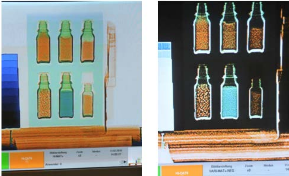
Abbildung 18 Test der Einzelkomponenten am Flughafen Bremen mit einem Smith Detection Hi-SCAN180180-2is Scanner. Materialdiskriminierungstest für Flüssigkeiten und Feststoffe.
