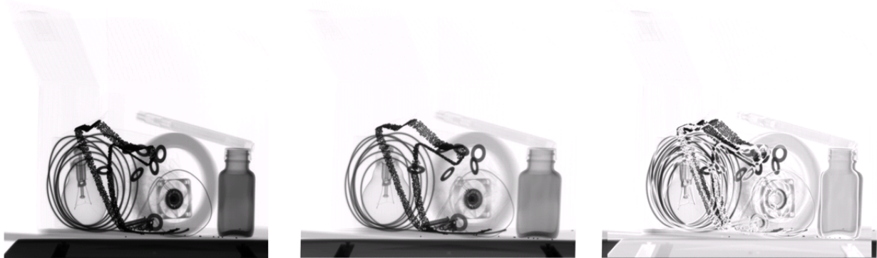
Abbildung 35 Beide Durchstrahlungsaufnahmen nach erfolgter affiner Transformation. Rechts das resultierende Differenzbild.
