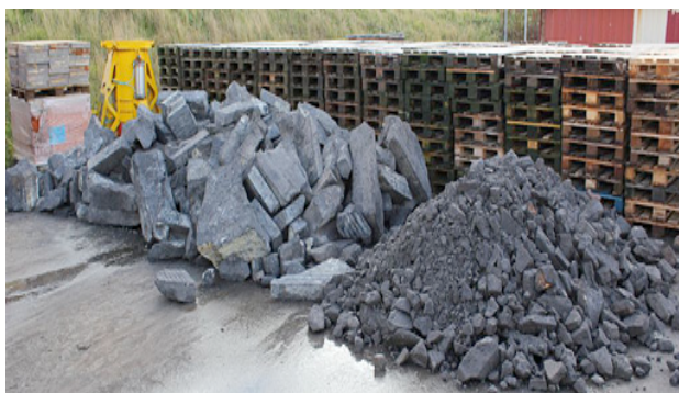
Abb.: 2 Kathodenausbruch (Hydro) Neuss
