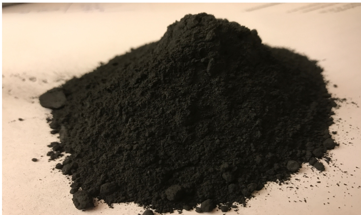
Abb.19: Kohlenstoff- Konzentrat aus Cut1 Laugung
