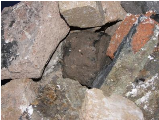
Abb.6: Feuerfest Ausbruch Cut2
