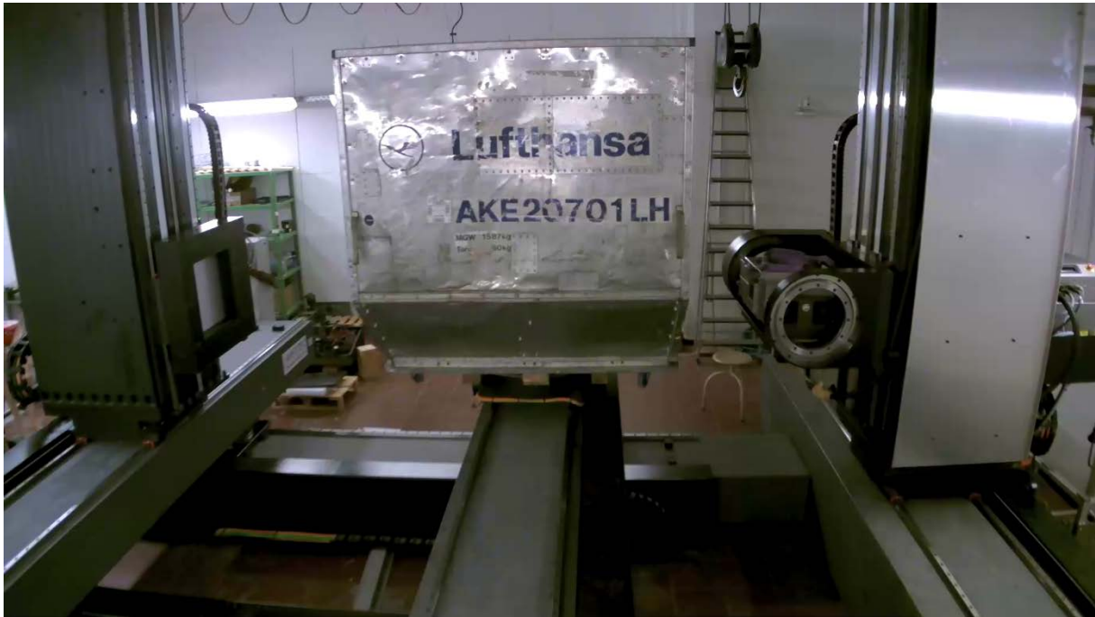
Abbildung 38 Abrastern des Luftfrachtcontainers mit Betatron (rechts) und hochauflösendem Flachdetektor (links). In der realen Messung befinden sich Betatron und Detektor dicht am Container.
