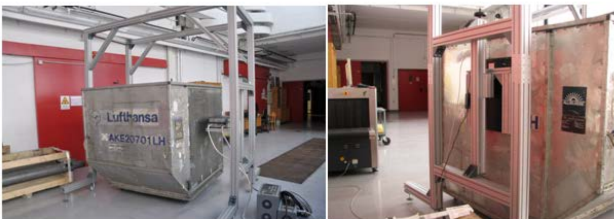
Abbildung 36 Die mobile Anlage im praktischen Einsatz. Linkes Bild: Strahlerseite mit montiertem Betatron. Rechtes Bild: Detektorseite.
