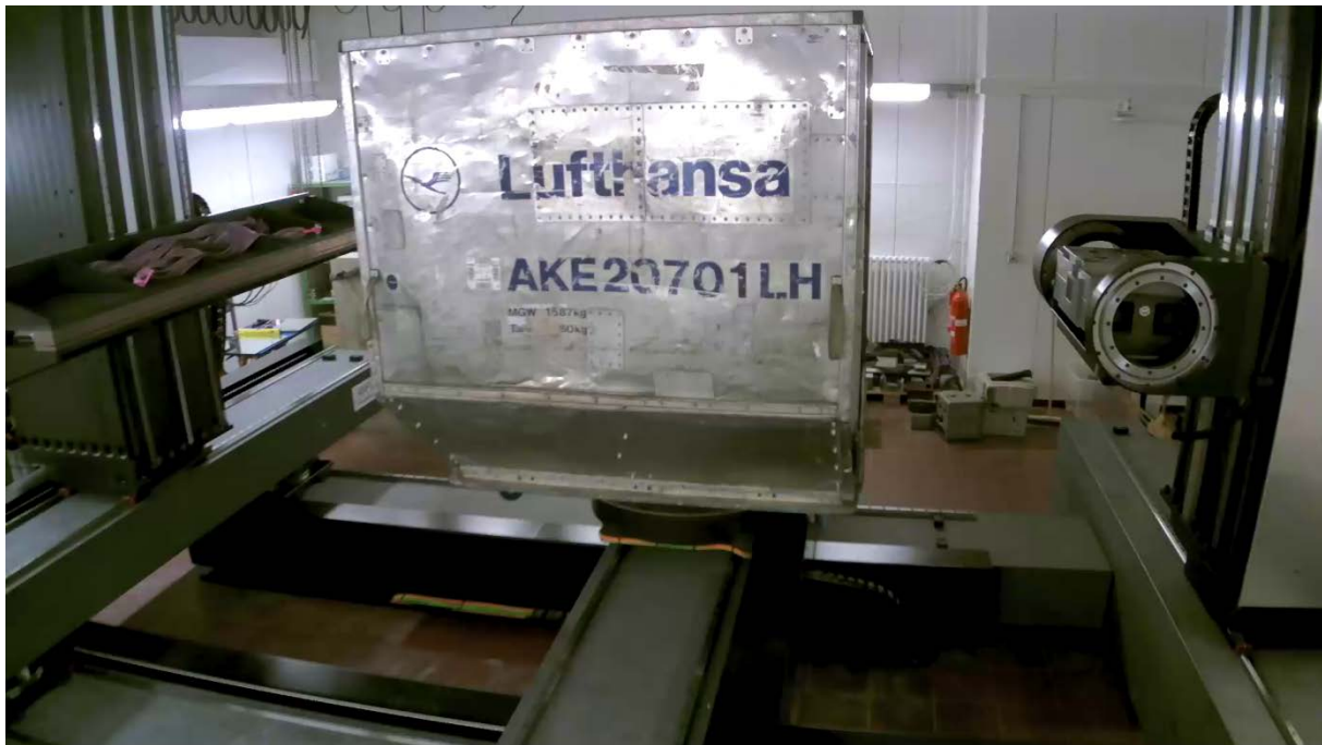
Abbildung 37 Schneller Hochenergie-Zeilenscan des Luftfrachtcontainers im Hexytech. Links im Bild der Zeilendetektor, rechts im Bild das Betatron. In der realen Messung befinden sich Betatron und Detektor dicht am Container.
